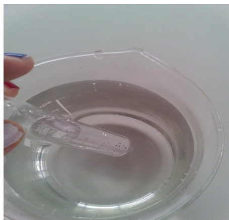
Obr 12.: Úplný odraz světla – mezní úhel pro vodu a vzduch (foto: Marie Vykydalová)
