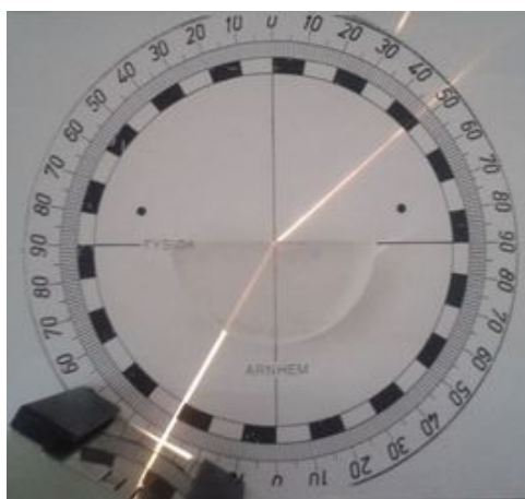
Obr. 3.: Znárodnění lomu světla od kolmice (zdroj: http://practicum.jouwweb.nl/practicum-optica )
