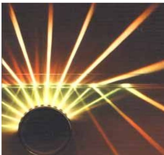
Obr. 4.: Demonstrace úplného odrazu světla (zdroj: Fyzika pro Gymnázia, str. 24)
