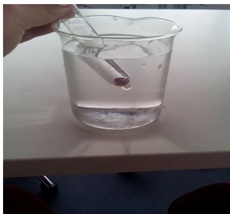
Obr 11.: Úplný odraz světla – viditelnost korálky z boku (foto: Marie Vykydalová)
