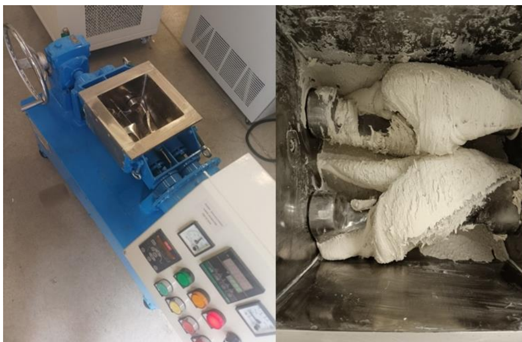
Obr. 35 – Hnětací stroj SNH-5 Kneader (vlevo) a pastovitá směs BMC v hnětači před přidáním skelných vláken (vpravo).
