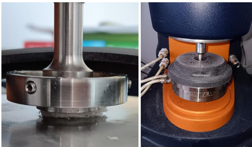
Obr. 54 – Vzorek nevytvrzeného BMC v gap1,5 mm (vlevo). Měření vzorku pomocí přístroje TA Instruments HR 20 pod teflonovým krytem (vpravo).
