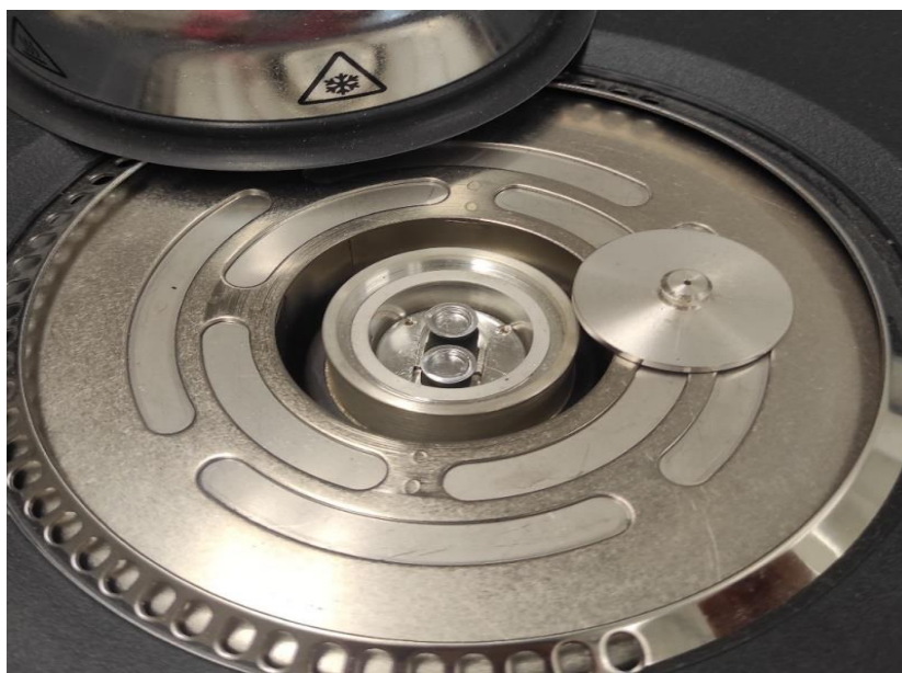
Obr. 62–T-zero Al pan uvnitř pícky TA Instruments DSC 250
