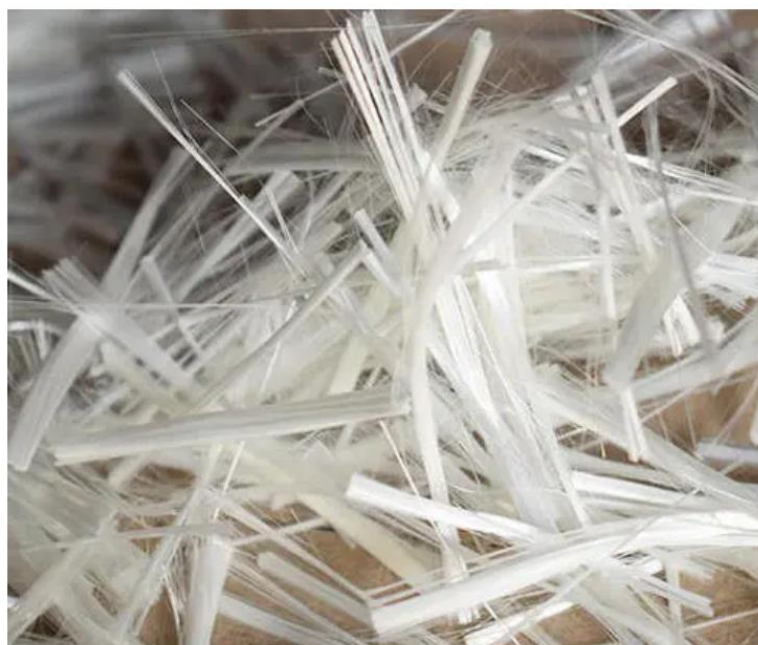
Obr. 16 – Skelná vlákna 6 mm. Převzato z 35
