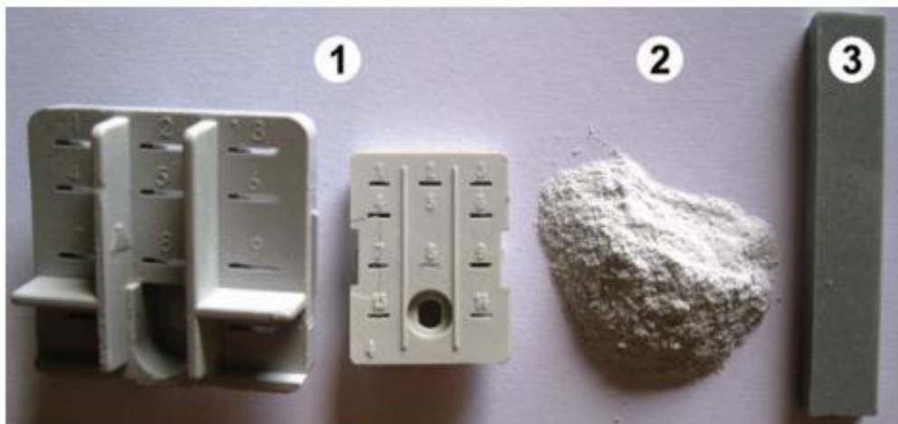
Obr. 22 – 1) Odpadní BMC díl 2) Recyklátový prášek 3) Vytvrzený epoxidový kompozit s 60% obsahem BMC recyklátu. Převzato a upraveno z 45
