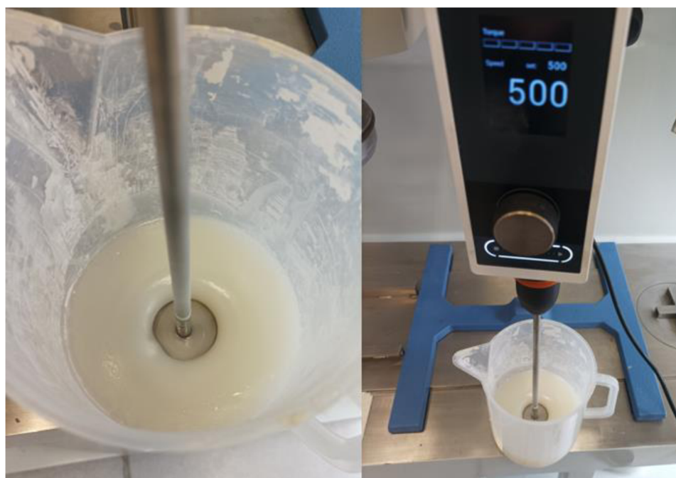
Obr. 34 – Míchání základní směsi viskózních složek.
