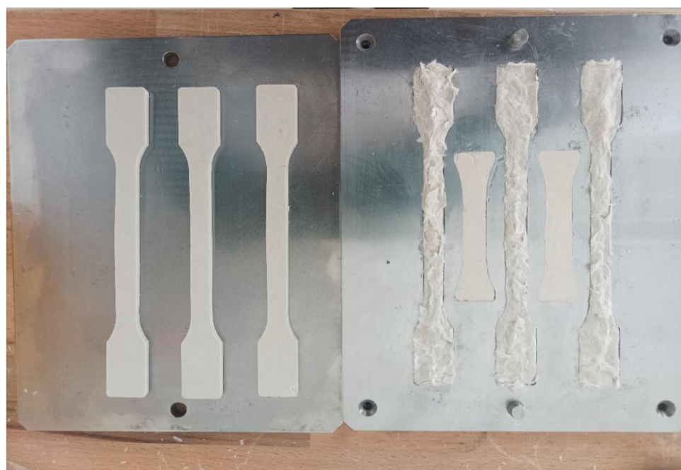
Obr. 41 – Ocelová forma pro lisování zkušebních těles pro tahové a ohybové zkoušky. Vylisované zkušební tělesa typu dogbone (vlevo) a naplněná forma nevytvrzeným BMC materiálem (vpravo)
