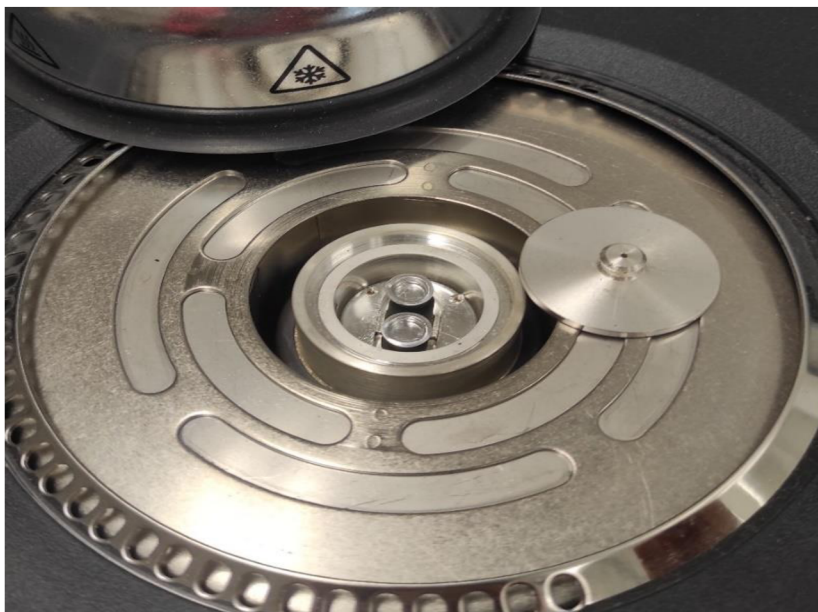
Obr. 62–T-zero Al pan uvnitř pícky TA Instruments DSC 250
