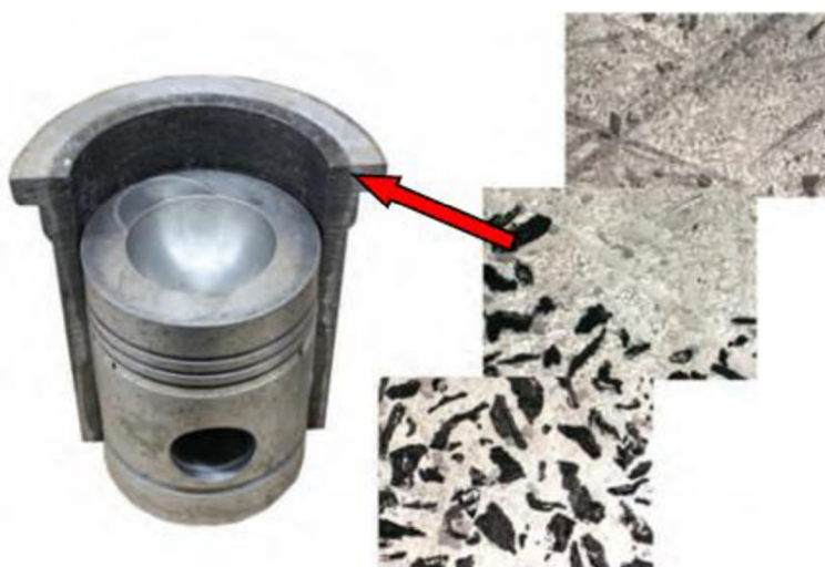
Obr. 3 – Píst a kompozitní válec vyrobený ze slitiny hliníku a grafitových částic vyvinutý v Centru pro kompozitní materiály Univerzity Wisconsin-Milwaukee. Převzato a upraveno 10
