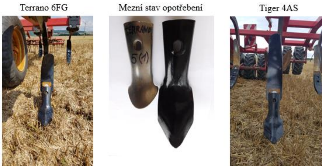
Obrázek 12 Kypřící radličky ClipOn 7,5
