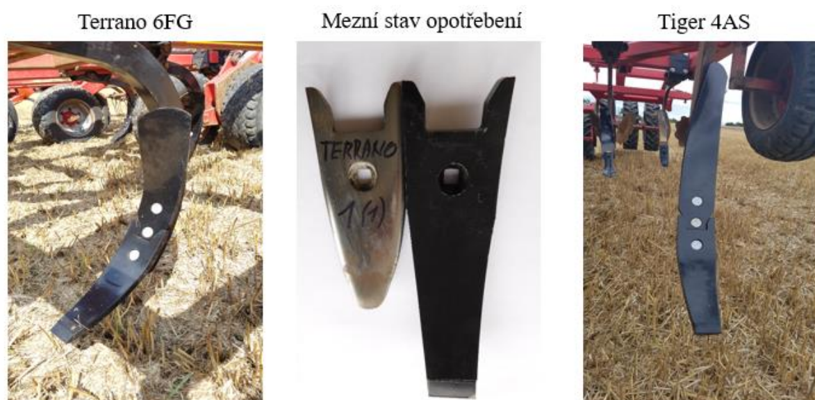
Obrázek 10 Kypřicí radličky MulchMix HM
