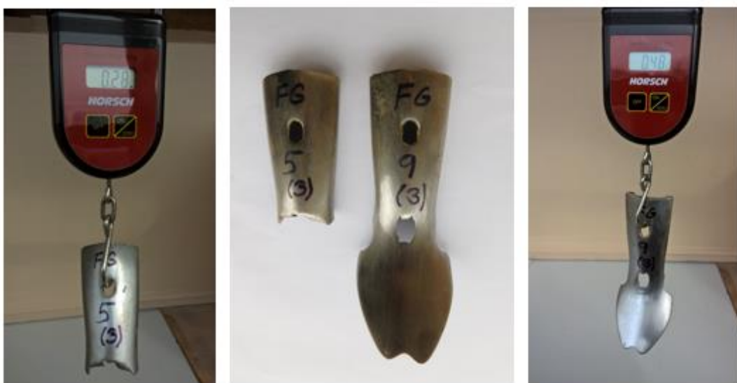
Obrázek 20 Ukázka nerovnoměrnosti opotřebení radliček ClipOn 7,5
