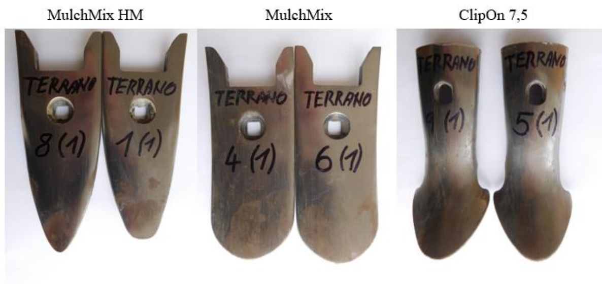
Obrázek 17 Ukázka stavu opotřebení u jednotlivých sad radliček
