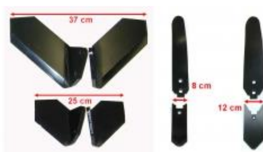
Obrázek 6 Varianty radliček systému MulchMix
