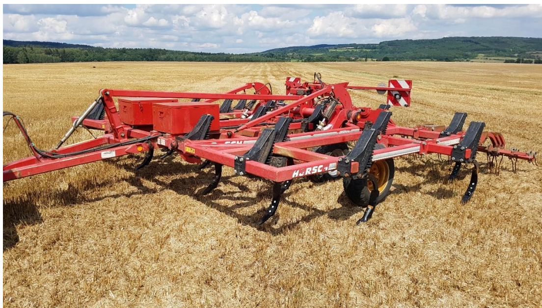
Obrázek 7 Radličkový kypřič Terrano 6FG
