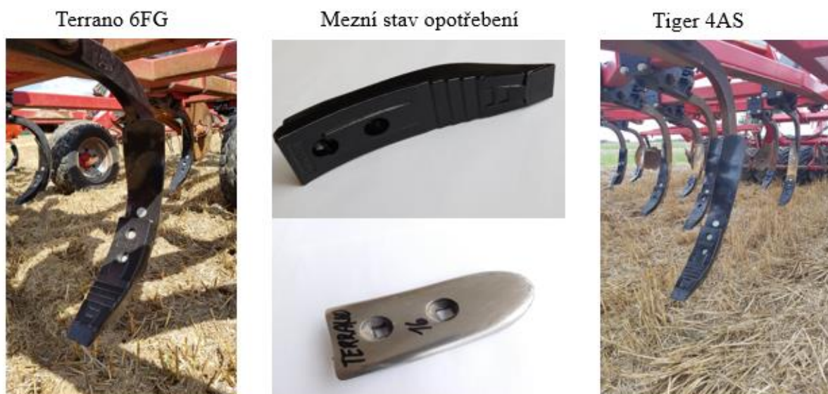
Obrázek 11 Kypřicí radličky MulchMix HM plus
