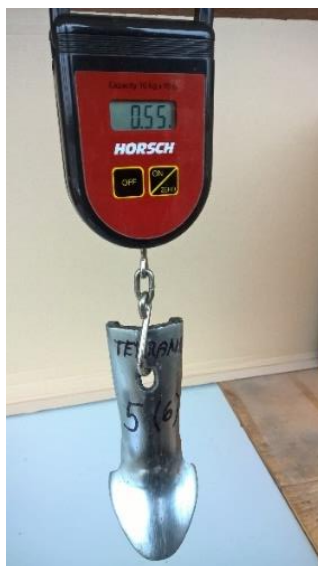
Obrázek 19 Měření hmotnosti opotřebovaných radliček
