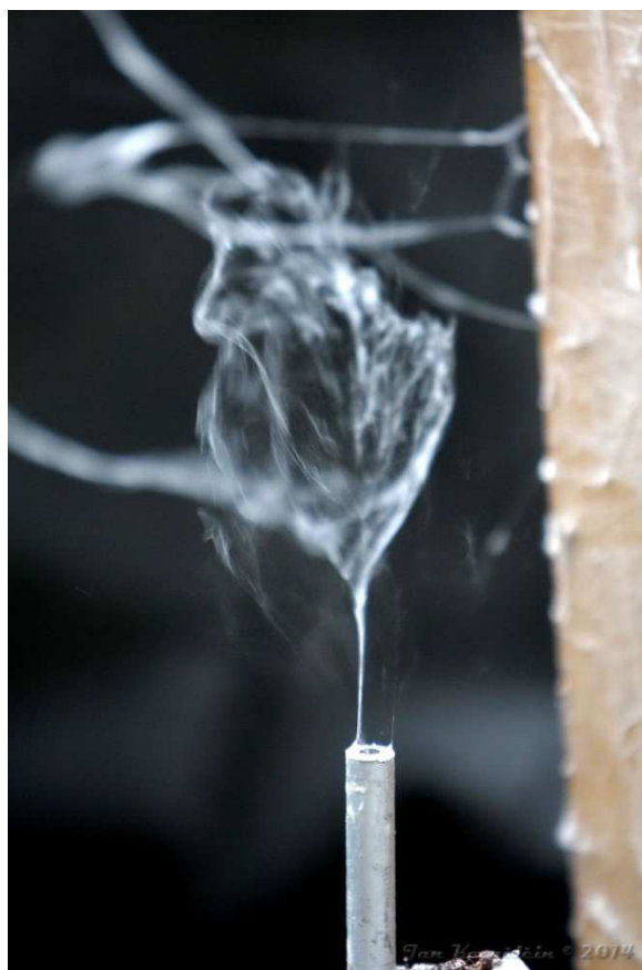
Obr. 28 – Detail trysky střídavého elektrostatického zařízení, ze které se tvoří nanovlákněný útvar.
