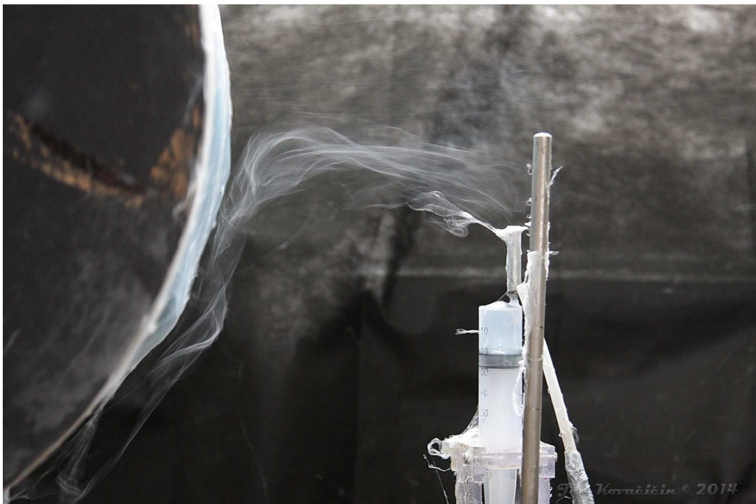
Obr. 35 – Svazek nanovláken unášený proudem vzduchu z trysky melt blownu. První testovaná metoda, konfigurace D. Z obrázku lze pozorovat tendenci svazku vláken k oblétání kolektoru. Jen část vláken se tedy zachytí na kolektoru.
