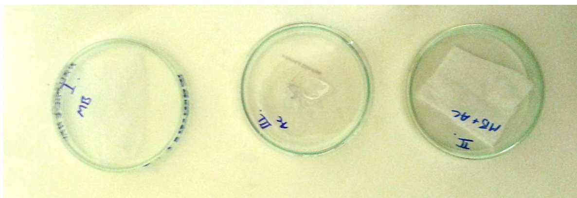
Obr. 50 – Fotografie zvážených vzorků zalitých etanolem, připravených k umístění do laboratorní třepačky na 24 hodin.
