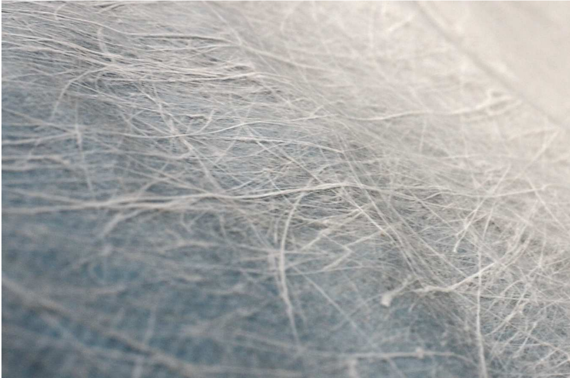
Obr. 36 – Fotografie struktury svazků nanovláken ve struktuře mikrovláken melt blownu. Metoda druhá, varianta konfigurace A.
