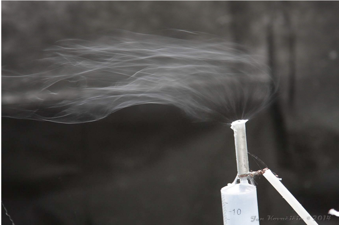
Obr. 34 – Detail trysky AC elektrospinningu. Svazek nanovláken je unášen proudem vzduchu z trysky melt blownu. První testovaná metoda, konfigurace C.
