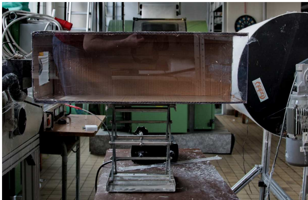
Obr. 43 – Fotografie ochranného krytu na pantografickém laboratorním stojanu. Kryt je umístěn mezi tryskou (nalevo) a kolektorem (vpravo).
