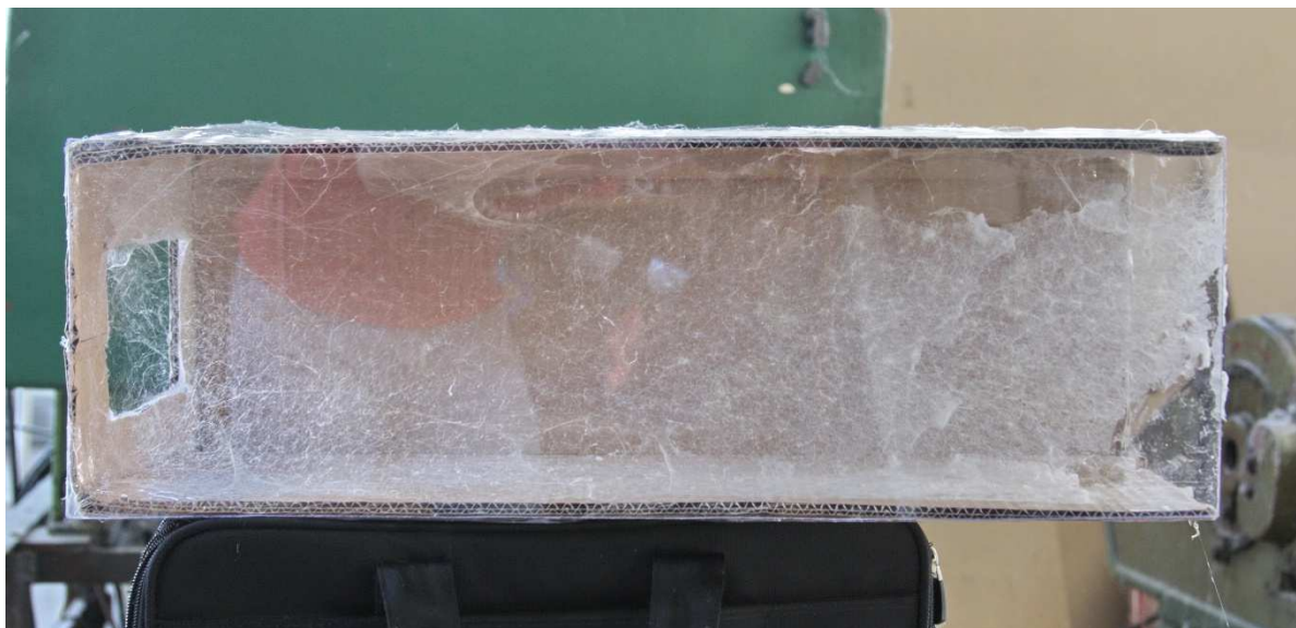
Obr. 44 – Snímek ochranného krytu po prvním a zároveň posledním experimentu, ve kterém byl použit. Na fotografii jsou patrné vláknenné nálety na stěnách krytu.
