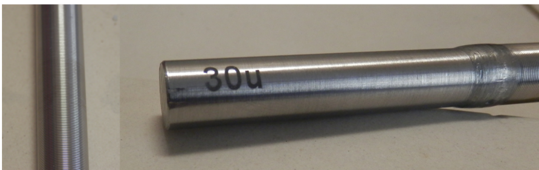
Obrázek 9: Používaná Mayerova tyč, velikost mokrého filmu 30 \mu\text{m}
