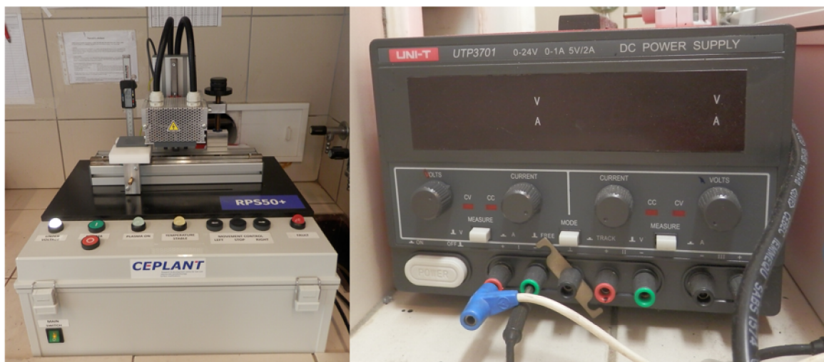
Obrázek 15: Vlevo přístroj na plazmochemické opracování, vpravo zařízení na regulaci napětí při plazmochemickém opracování
