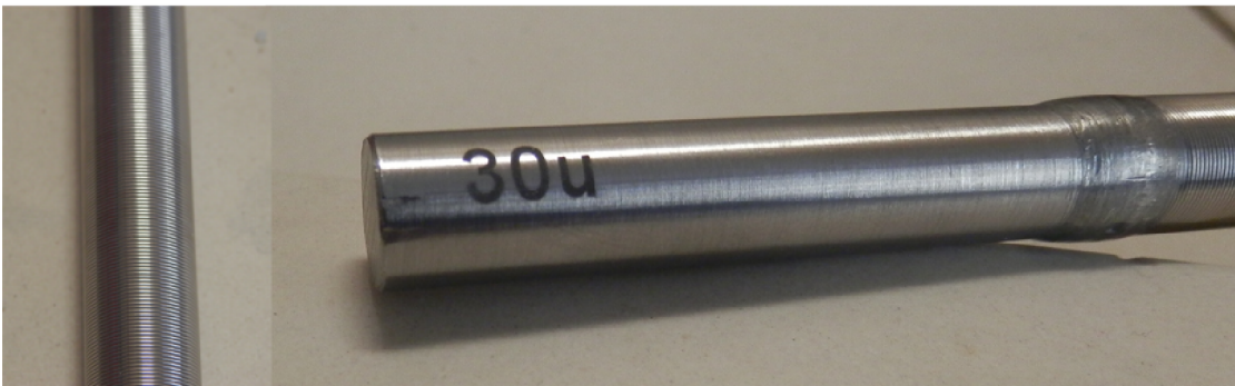
Obrázek 9: Používaná Mayerova tyč, velikost mokrého filmu 30 \mu\text{m}
