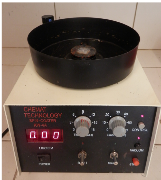
Obrázek 16: Přístroj spin coater na přípravu tenké vrstvy modelové látky AO7
