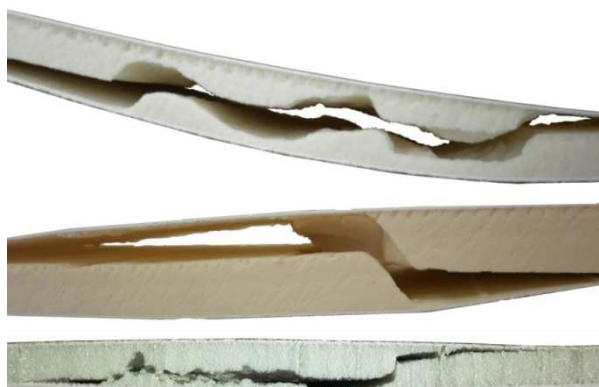
Obr. 6.7 Delaminace a prasknutí výplně
