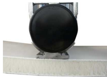
Obr. 5.4 Podložka mezi zatěžovacím trnem a zkušebním tělesem pro rozložení zatížení
