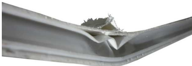
Obr. 6.8 Destrukce voštin a prasknutí potahového materiálu
