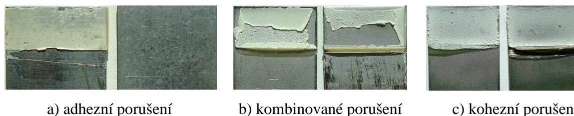
Obr. 6.22 Druhy porušení lepeného spoje
