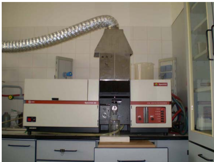
Obrázek č. 14: SpectrAA 30 (Varian, Austrálie).
