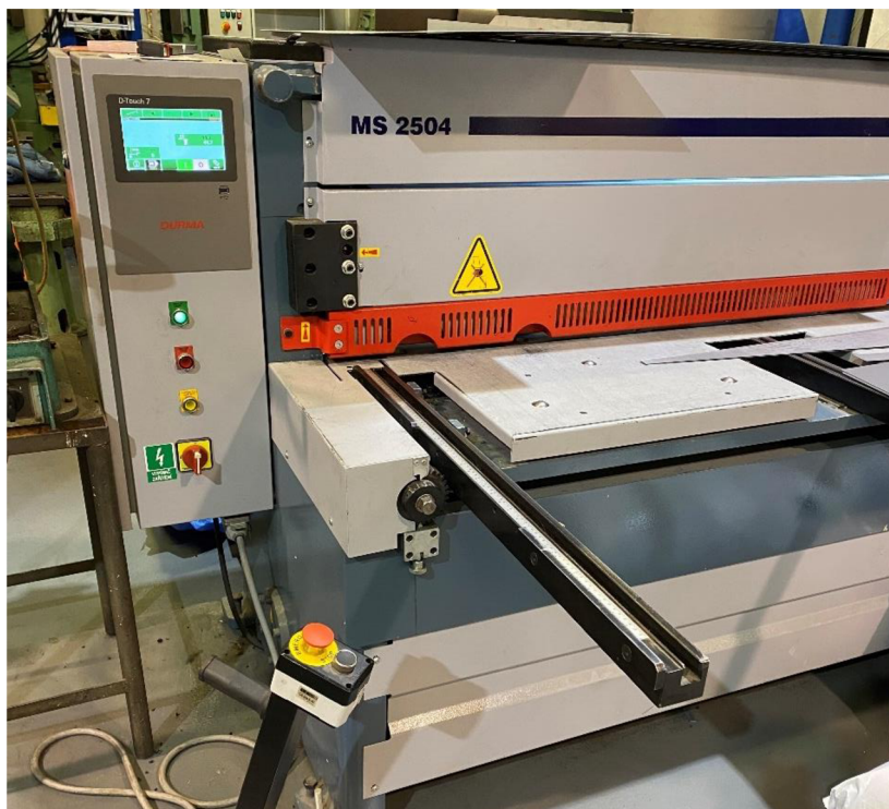
Obr. 18 Elektromagnetické tabulové nůžky MS 2504
