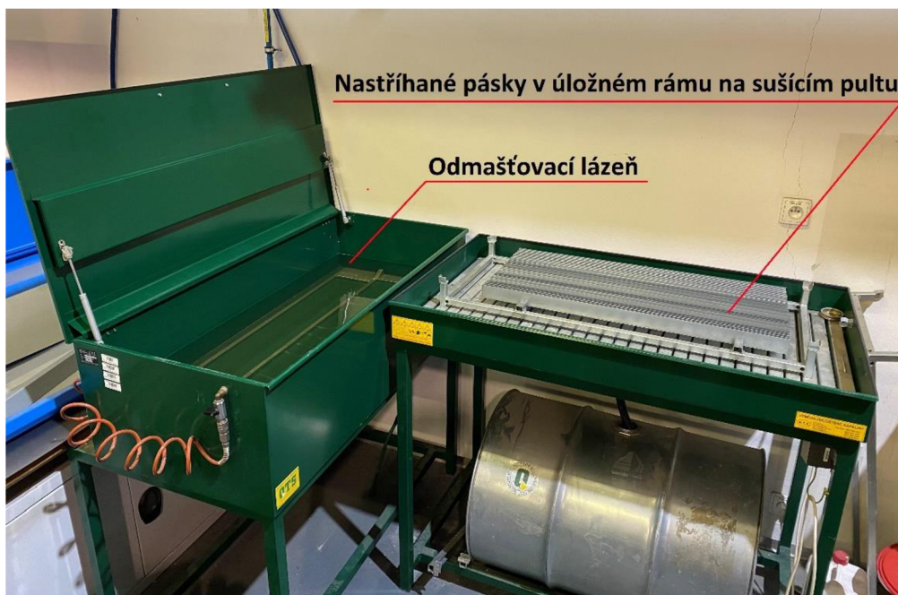
Obr. 19 Pracoviště odmašťovací lázně
