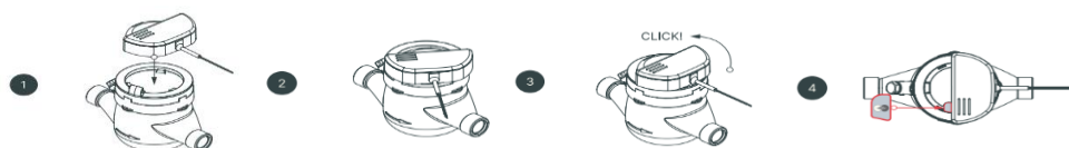
Obrázek 4: Připojení kabelového modulu na vodoměr (zdroj: bmeters.com)
