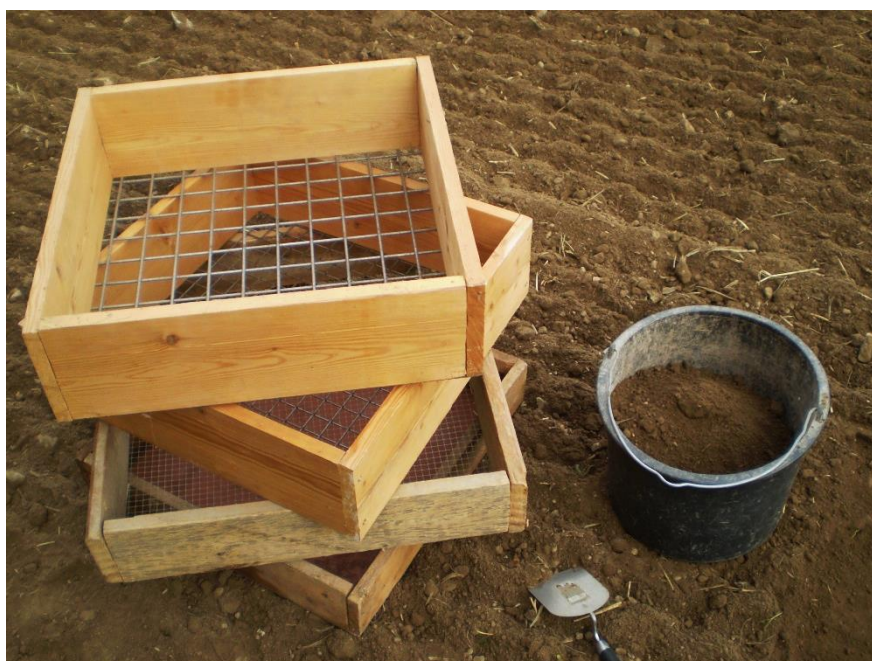
Obrázek 23 - Soustava sít pro měření hmotnosti frakcí hrud (Vlastní zdroj, 2017)
