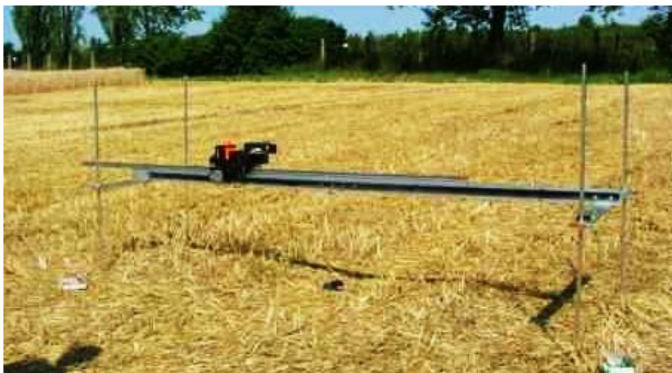
Obrázek 8 - Laserový profilograf (Mayer a kol., 2004)
