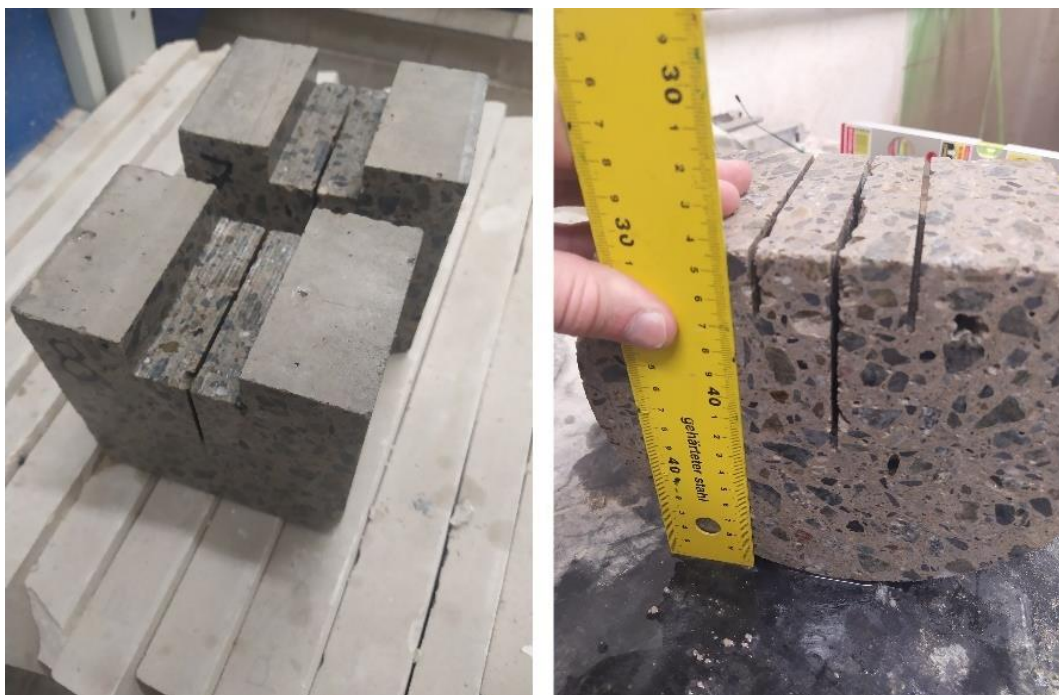
Obr. 47: Příprava těles pro lomové zkoušky
