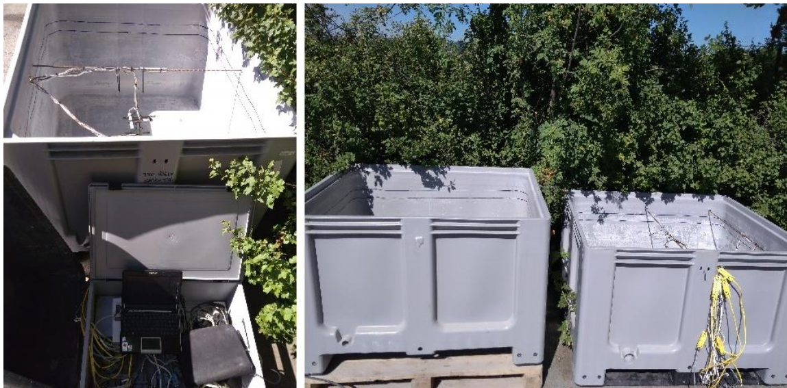
Obr. 39: Forma pro výrobu betonového bloku [fotoarchiv řešitelského kolektivu projektu GAČR č. 19-22708S].
