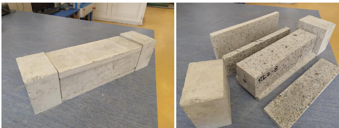
Obr. 22: Výřez menšího hranolu z tělesa většího rozměru.
