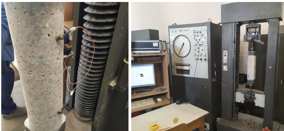
Obr. 27: Měření metodou akustických emisí za účelem sledování porušení betonu během zkoušky.
