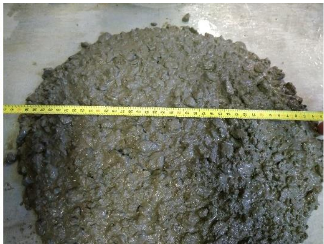
Obr. 16: Zkouška rozlití [fotoarchiv řešitelského kolektivu projektu GAČR č. 19-22708S].
