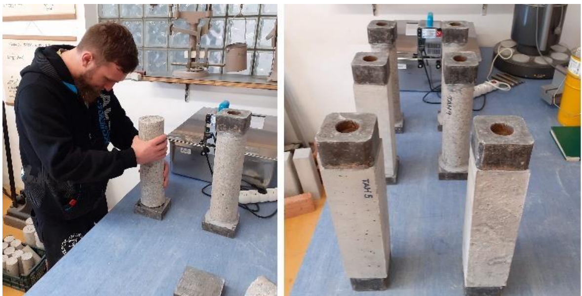
Obr. 42: Příprava těles pro zkoušení prostým tahem.
