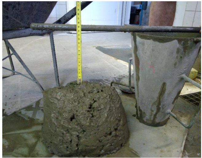
Obr. 15: Zkouška sednutí kužele [fotoarchiv řešitelského kolektivu projektu GAČR č. 19-22708S].
