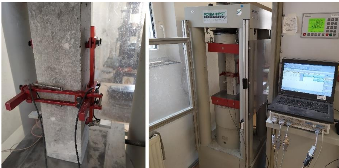
Obr. 35: Zkouška pro stanovení statického modulu pružnosti.
