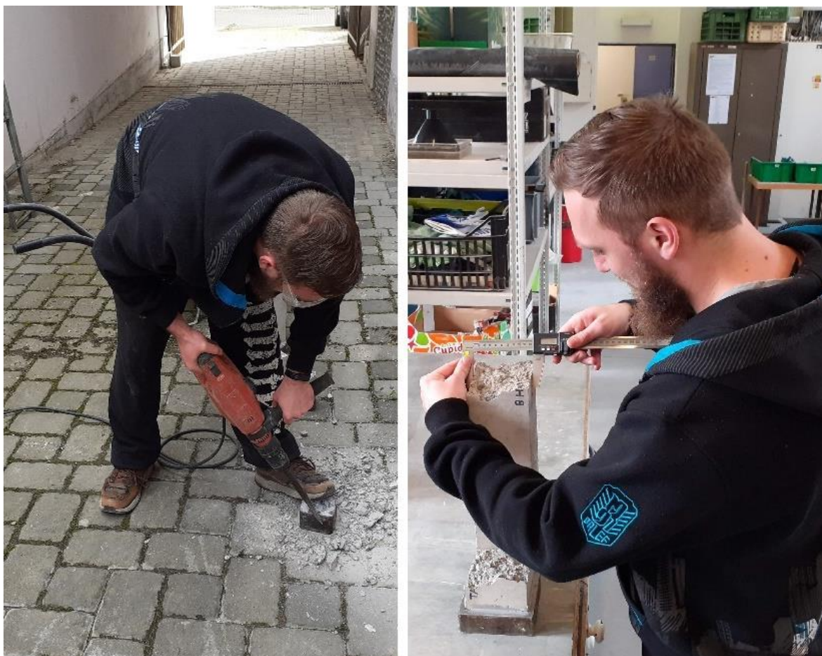
Obr. 43: Záznam těles a čištění přípravku po zkoušce prostým tahem
