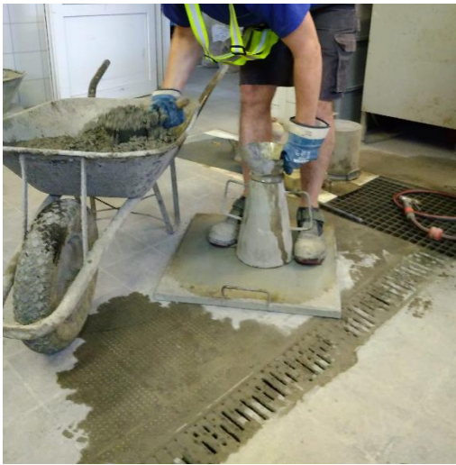
Obr. 15: Zkouška sednutí kužele [fotoarchiv řešitelského kolektivu projektu GAČR č. 19-22708S].
