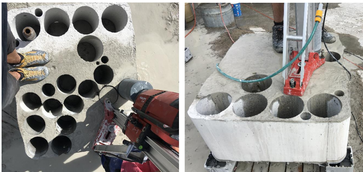
Obr. 20: Odběr těles větších průměrů z bloků jádrovým vrtáním [fotoarchiv řešitelského kolektivu projektu GAČR č. 19-22708S].
