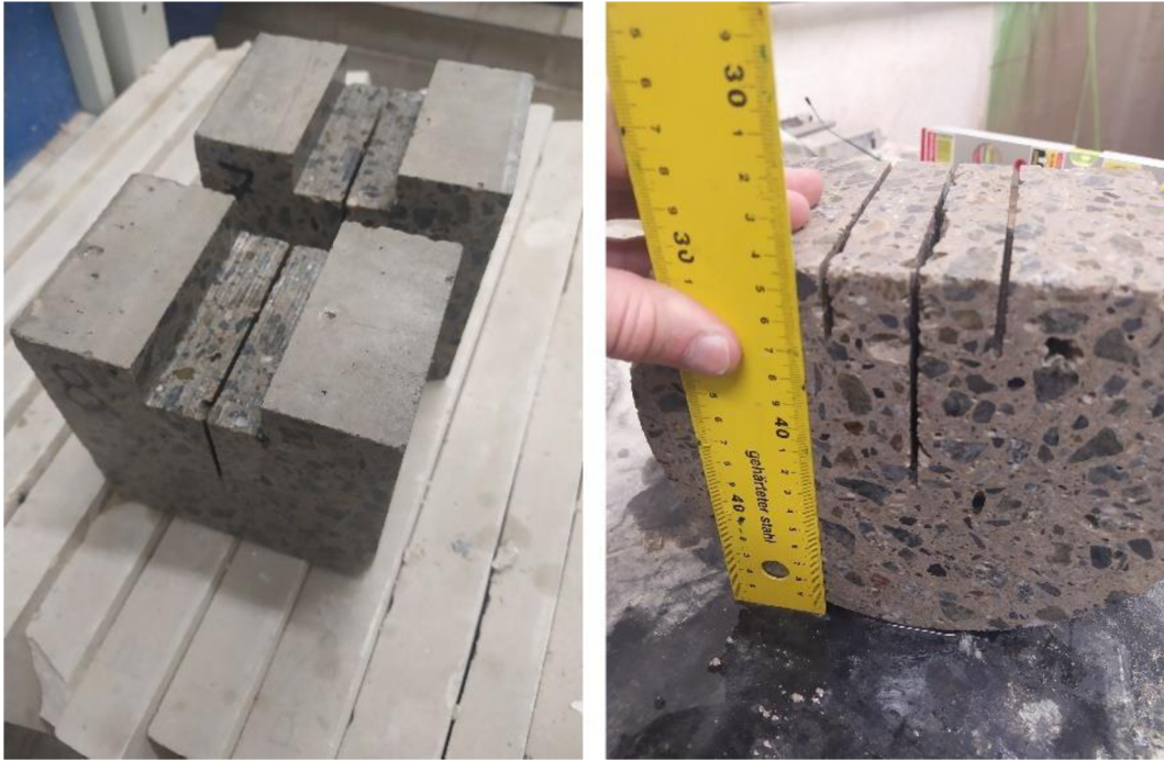
Obr. 47: Příprava těles pro lomové zkoušky
