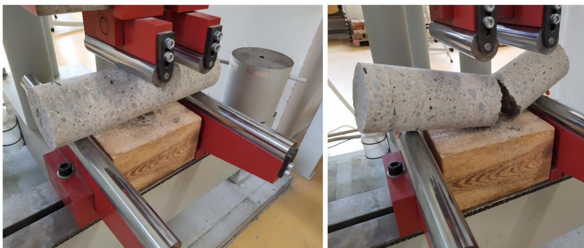
Obr. 31: Zkouška čtyřbodovým ohybem [fotoarchiv řešitelského kolektivu projektu GAČR č. 19-22708S].
