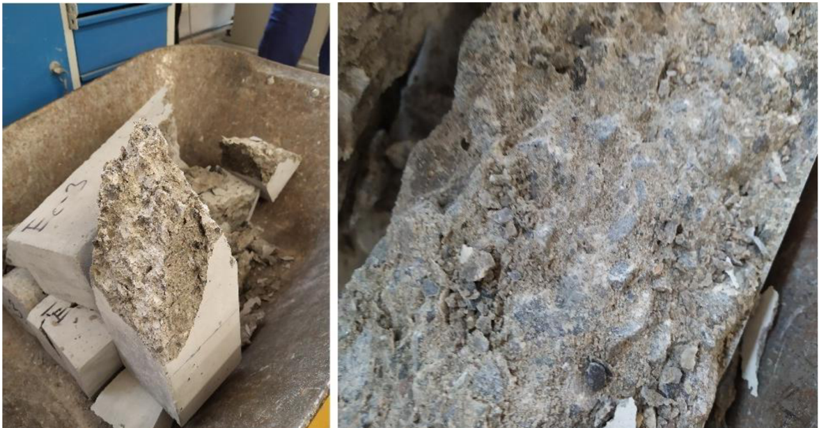
Obr. 44: Porušení těles po zkoušení statického modulu pružnosti v tlaku
