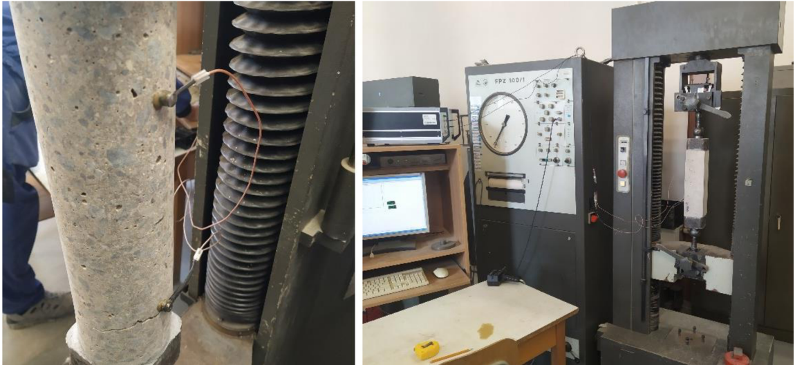
Obr. 27: Měření metodou akustických emisí za účelem sledování porušení betonu během zkoušky.
