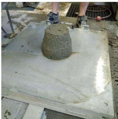
Obr. 16: Zkouška rozlití [fotoarchiv řešitelského kolektivu projektu GAČR č. 19-22708S].
