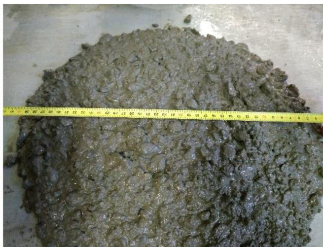
Obr. 16: Zkouška rozlití [fotoarchiv řešitelského kolektivu projektu GAČR č. 19-22708S].
