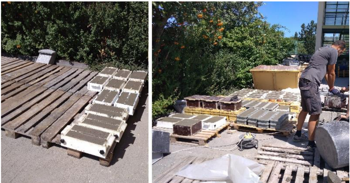
Obr. 19: Výroba těles z čerstvého betonu [fotoarchiv řešitelského kolektivu projektu GAČR č. 19-22708S].
