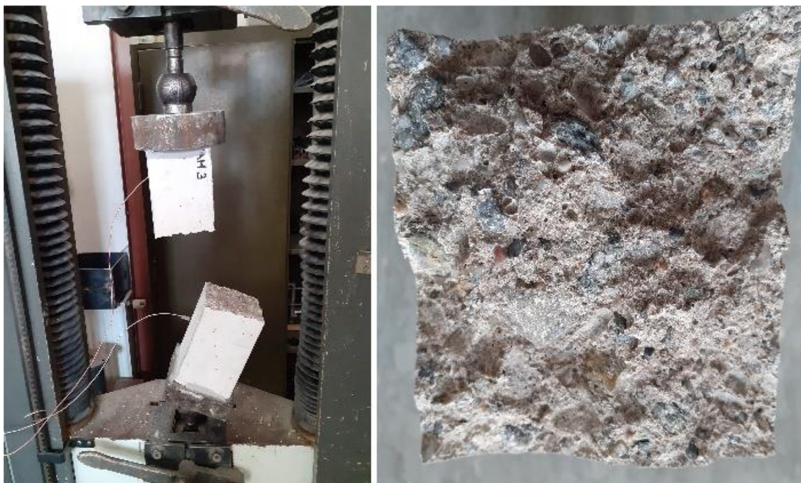
Obr. 41: Zkoušení prostým tahem [fotoarchiv řešitelského kolektivu projektu GAČR č. 19-22708S].
