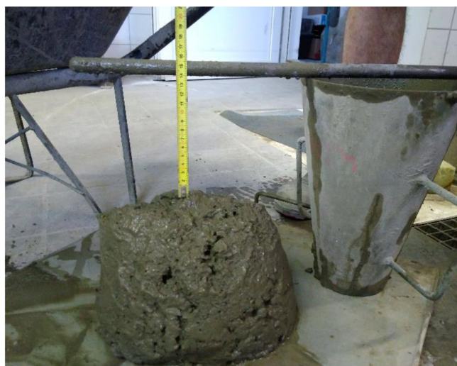
Obr. 15: Zkouška sednutí kužele [fotoarchiv řešitelského kolektivu projektu GAČR č. 19-22708S].
