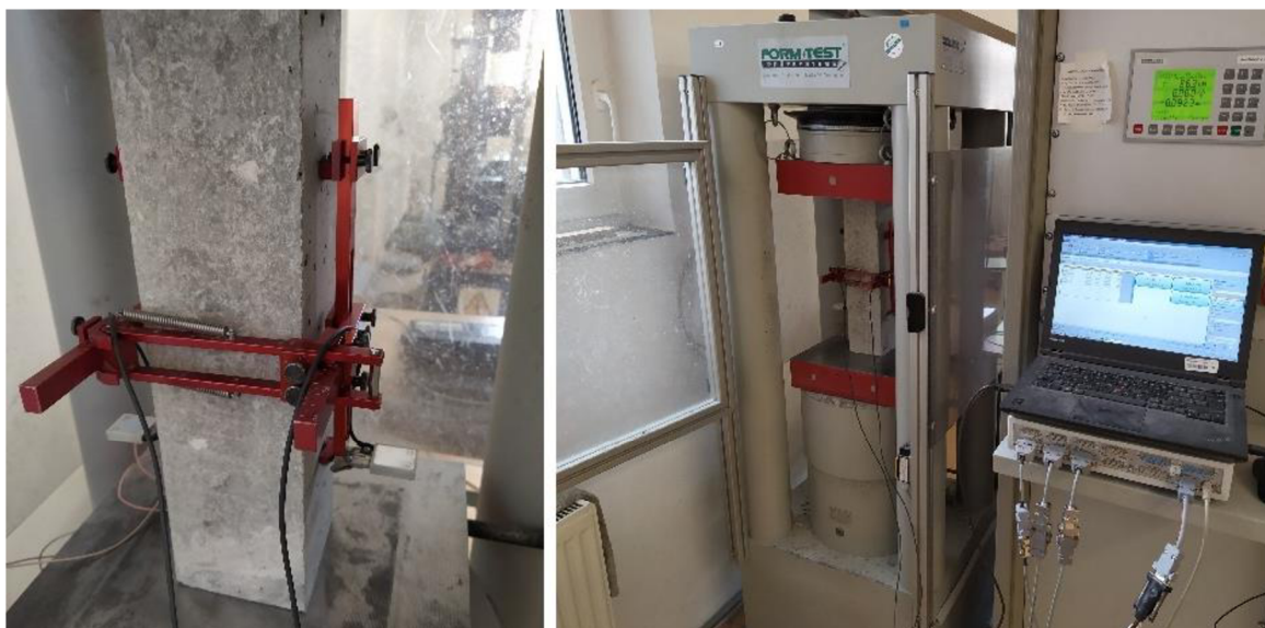
Obr. 35: Zkouška pro stanovení statického modulu pružnosti.
