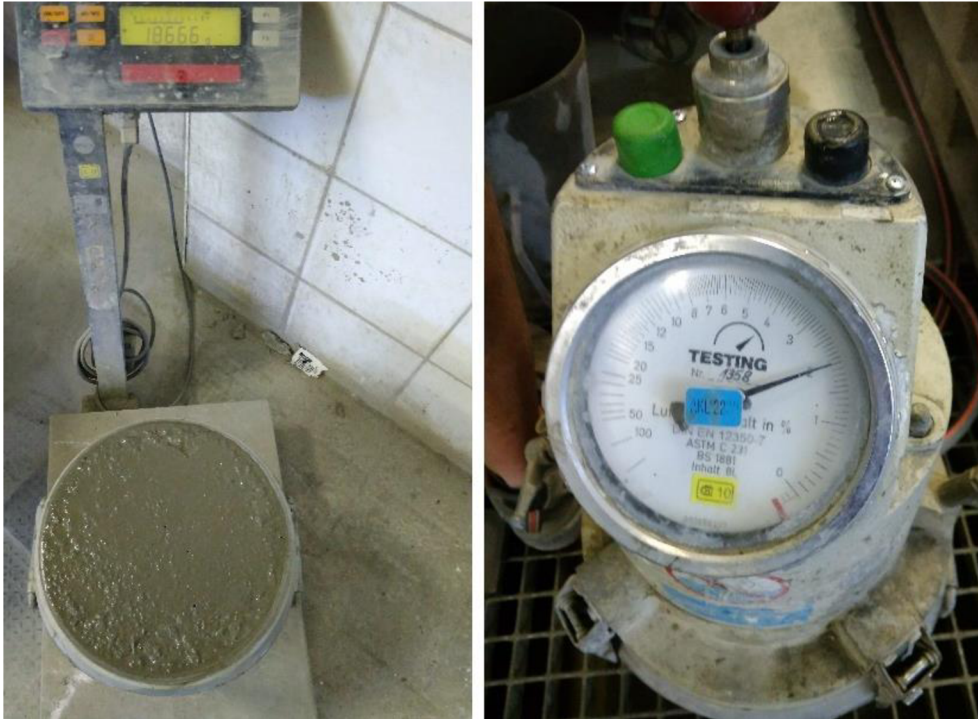
Obr. 17: Zkouška obsahu vzduchu tlakovým hrncem [fotoarchiv řešitelského kolektivu projektu GAČR č. 19-22708SJ].
