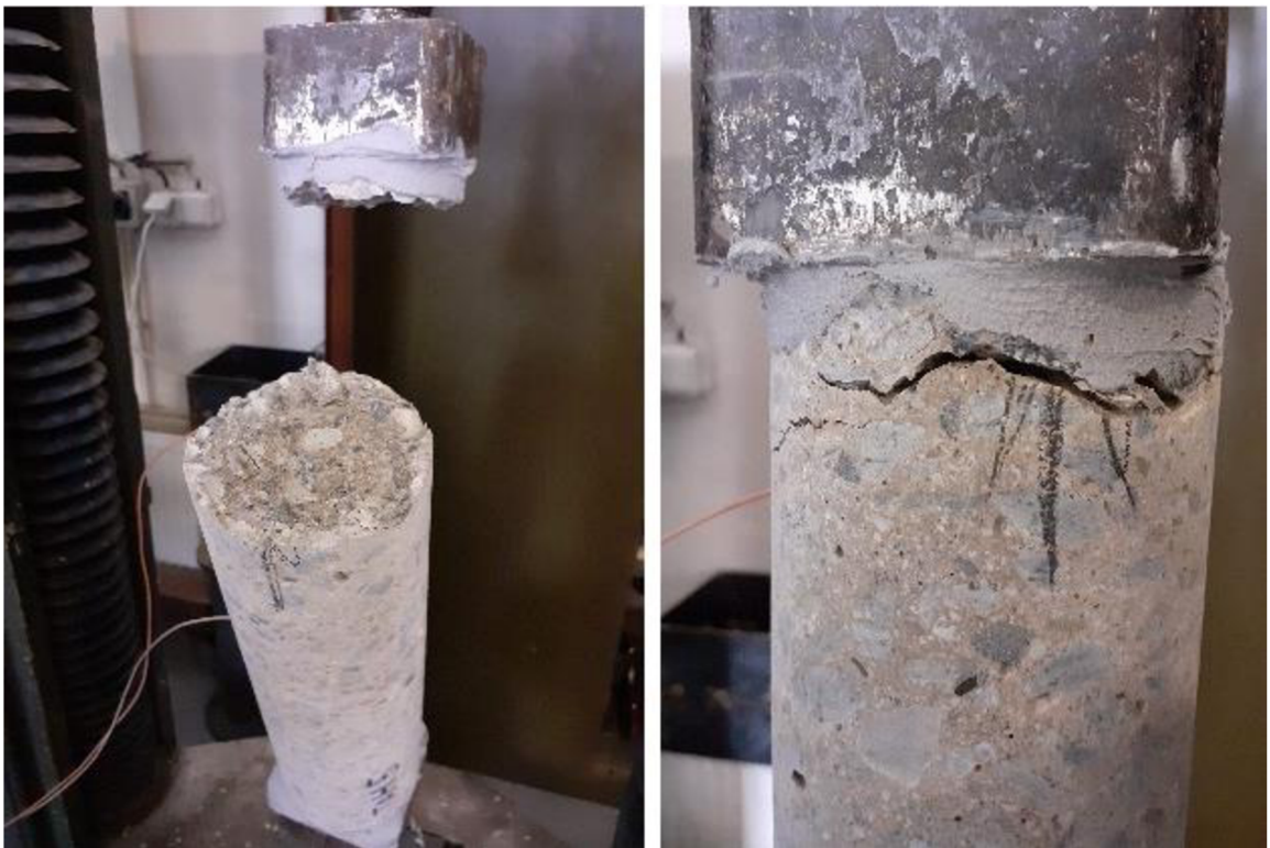
Obr. 40: Zkoušení prostým tahem [fotoarchiv řešitelského kolektivu projektu GAČR č. 19-22708S].
