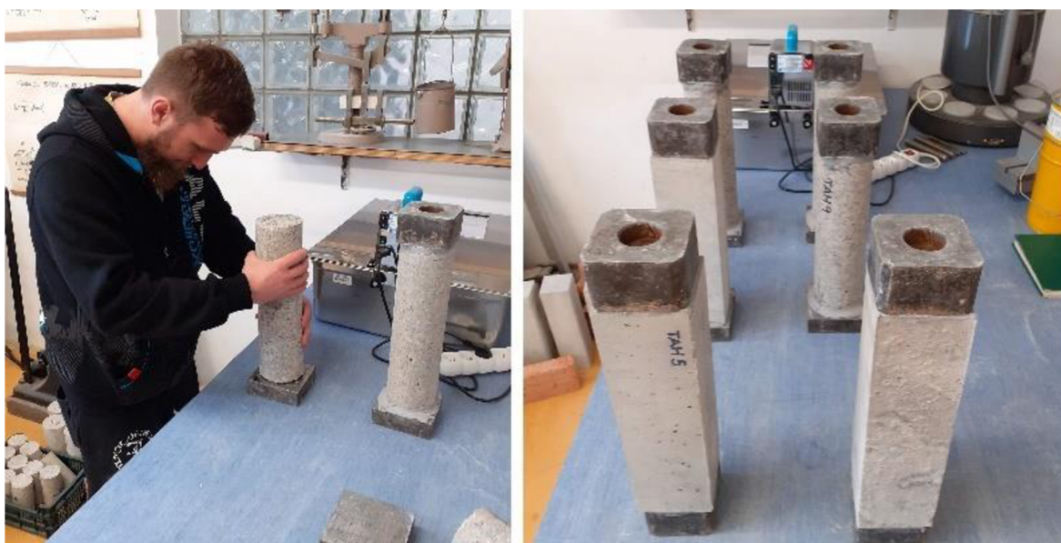
Obr. 42: Příprava těles pro zkoušení prostým tahem.
