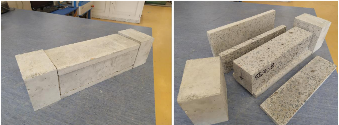
Obr. 22: Výřez menšího hranolu z tělesa většího rozměru.
