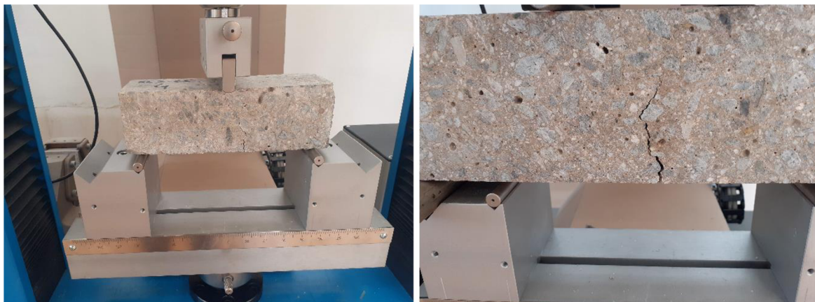
Obr. 30: Zkouška tříbodovým ohybem [fotoarchiv řešitelského kolektivu projektu GAČR č. 19-22708S].
