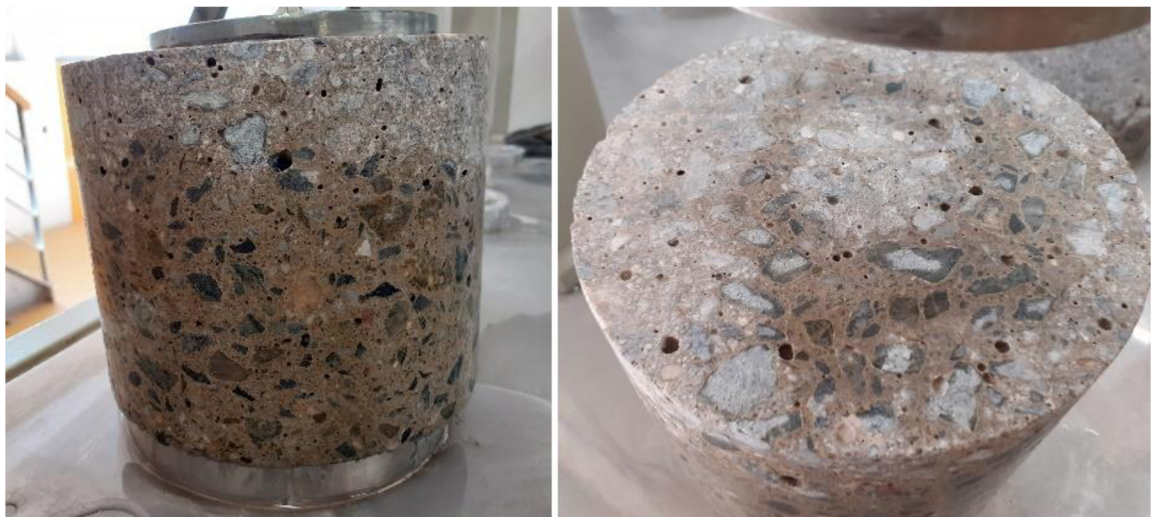
Obr. 46: Zkoušení průsaku tlakovou vodou [fotoarchiv řešitelského kolektivu projektu GAČR č. 19-22708S].
