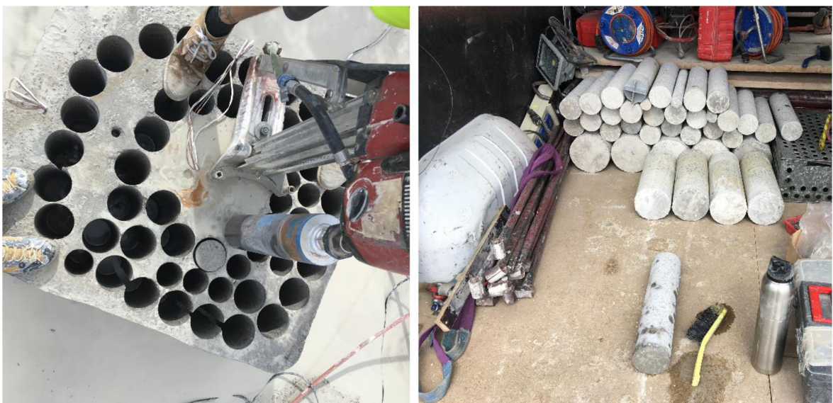
Obr. 21: Vlevo odběr těles menších průměrů z bloků jádrovým vrtáním, vpravo přehled těles [fotoarchiv řešitelského kolektivu projektu GAČR č. 19-22708S].
