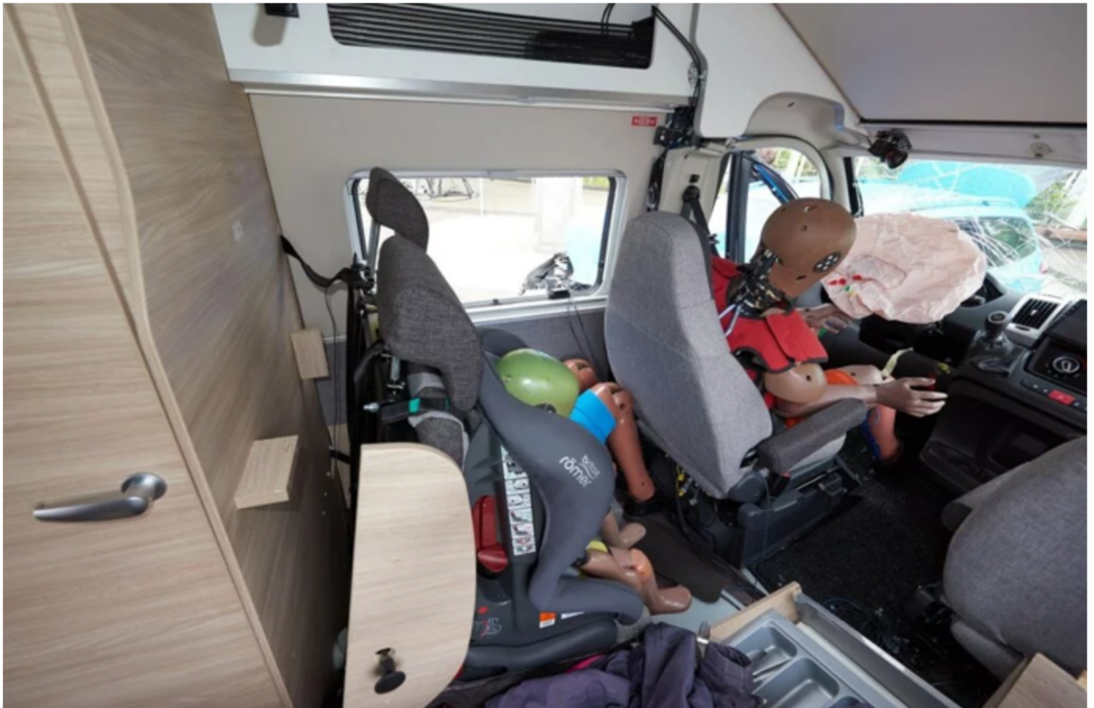
Obrázek 4 - Karavan po testu nárazu s osobní automobílem (zdroj: camperlife.cz)
