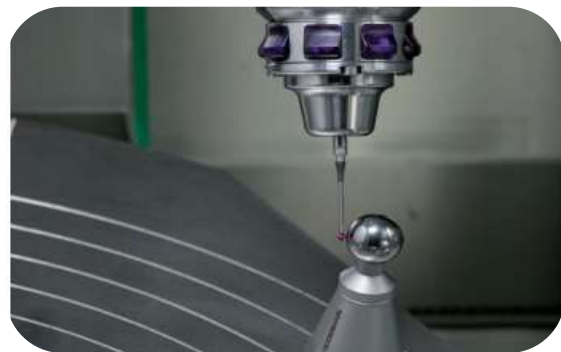
Obr. 11.1 Měření geometrické přesnosti pomocí obrobkové sondy [45]
