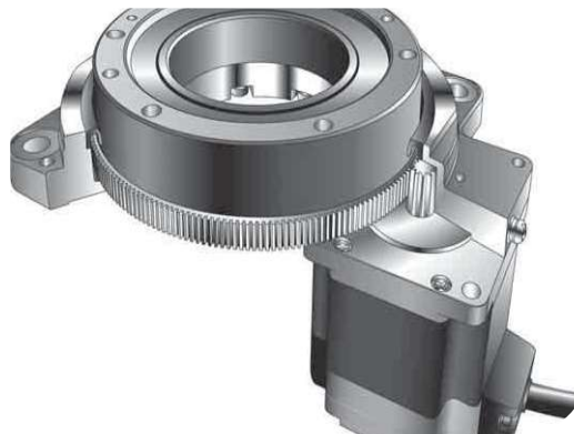
Obr. 5.1.1 Převod čelním ozubením u otočného stolu [12]
