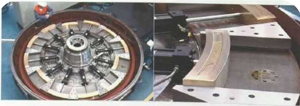
Obr. 7.1.1 - Hydrostatické ložisko s možností změny průměru [13]
