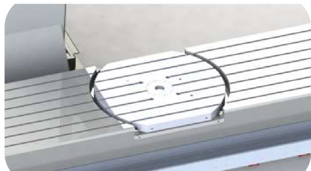
Obr. 6.2. Otočná upínací deska v kombinaci s nepohyblivým posuvným stolem [21]
