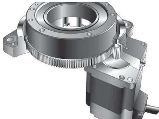
Obr. 5.1.1 Převod čelním ozubením u otočného stolu [12]
