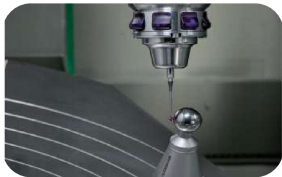
Obr. 11.1 Měření geometrické přesnosti pomocí obrobkové sondy [45]
