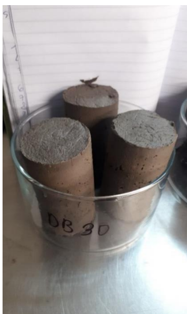
Obrázek 7: Vzorek DB 30 po vyjmutí z PVC formy po dvou dnech v digestoři.
