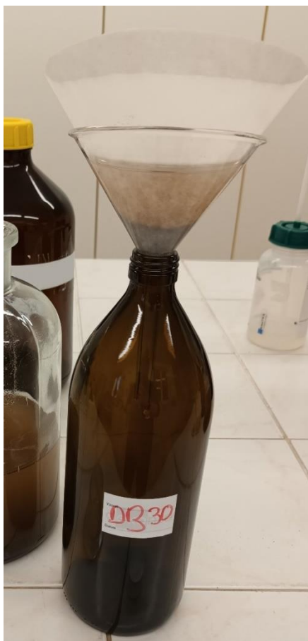
Obrázek 10: Přefiltrování 1 litru výluhu do připravené nádoby k odeslání na analýzu výluhů
