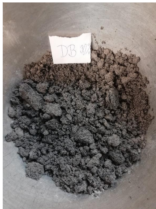
Obrázek 3: Kal se 30% dávkou aditiva DAS B během procesu homogenizace.
