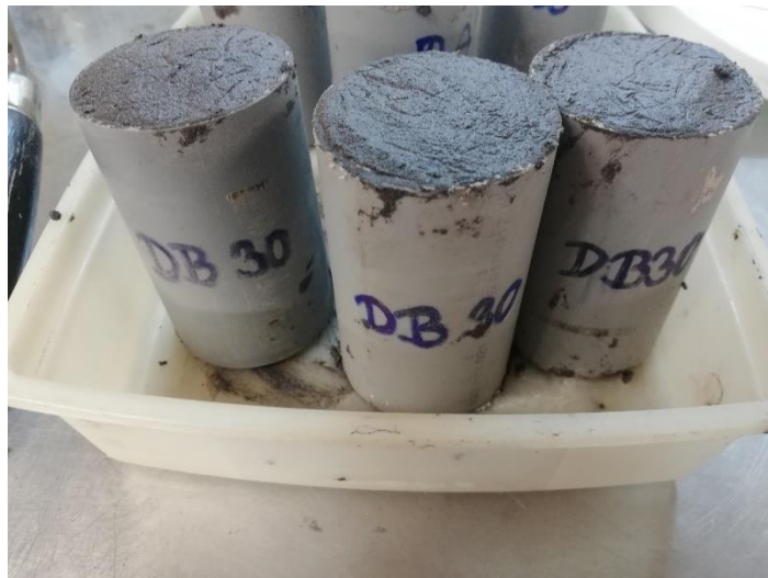
Obrázek 6: Naplněné PVC formy s mísicím poměrem DB 30 před vložením do digestoře.
