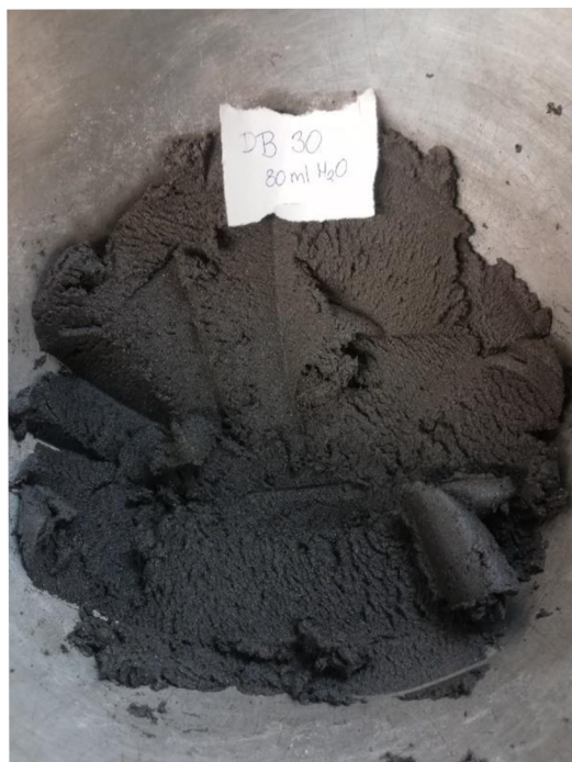
Obrázek 4: Kal po homogenizaci se 30% dávkou aditiva DAS B a po přidání 80 ml destilované vody.
