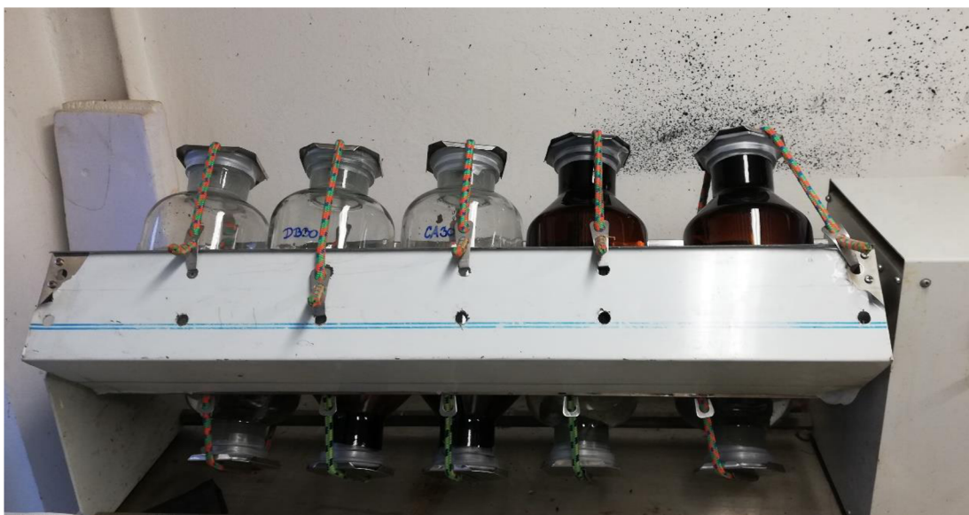
Obrázek 9: Třepačka se vzorky před jejich vyluhováním
