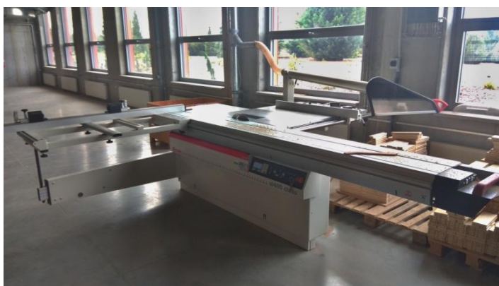
Obrázek 21 Formátovací pila SCM si 300 class
