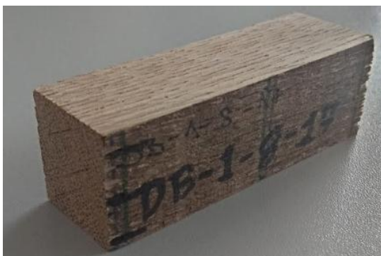
Obrázek 20 Ukázka vzorku po úpravě pilovým kotoučem
