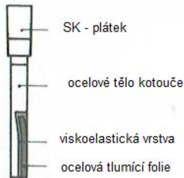
Obrázek 17 Kotouč s protihlukovou úpravou
