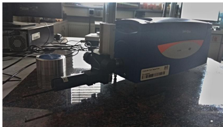
Obrázek 23 Kontaktní profilometr Form Talysurf 50 Intra 2
