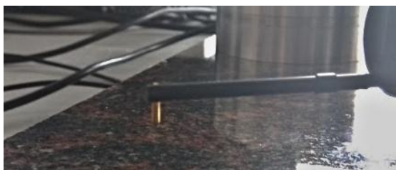
Obrázek 26 Snímací raménko profilometru
