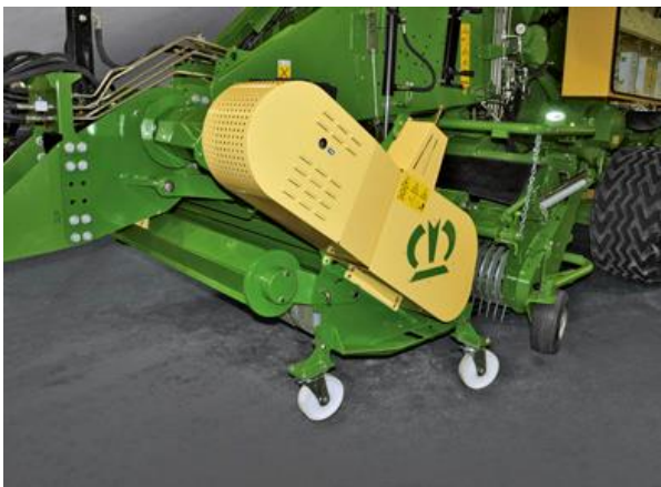
Obr. 59 Demontáž předřadného drtiče lisu Krone [23]
