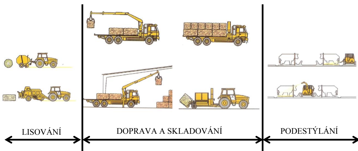
Obr. 4 Schématické znázornění sklizně slámy lisováním s následným úklidem balíků za pomoci automobilu s hydraulickou rukou [3]
