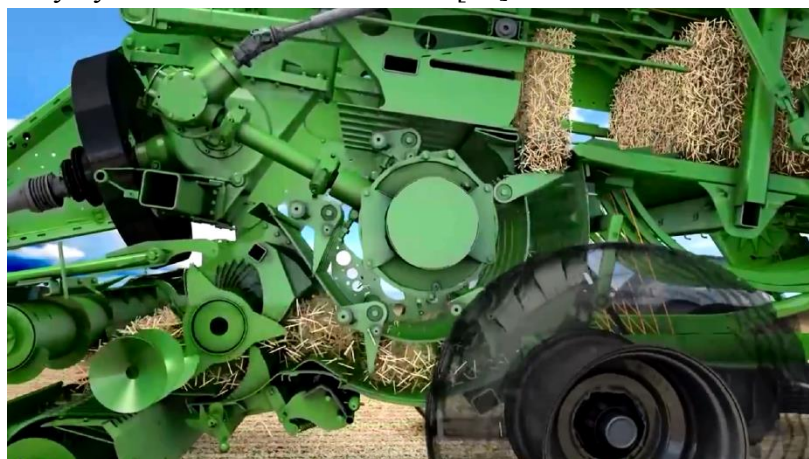
Obr. 61 Dopravení materiálu do lis. komory u lisu Krone [23]
