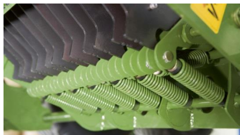
Obr. 54 Jednotlivé jištění nožů lisu Krone [23]
