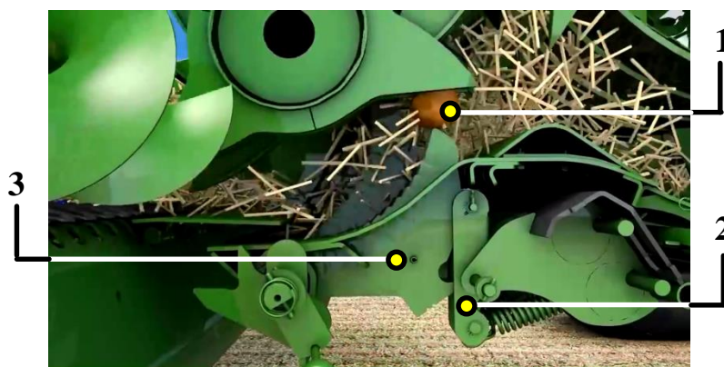
Obr. 55 Princip jištění nože u řezacího ústrojí lisu Krone [23]
