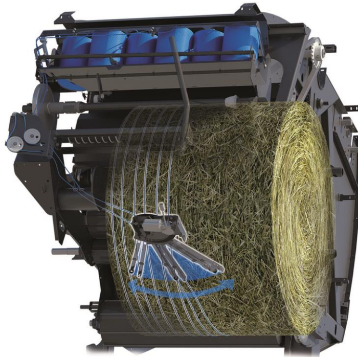
Obr. 32 Činnost vázacího mechanismu u firmy New Holland [21]
