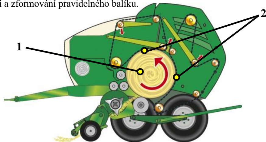
Obr. 26 Lis Krone s variabilní lisovací komorou [23]
