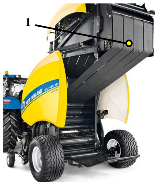
Obr. 29 Lis s variabilní lisovací komorou a gumovými pásy [21]
