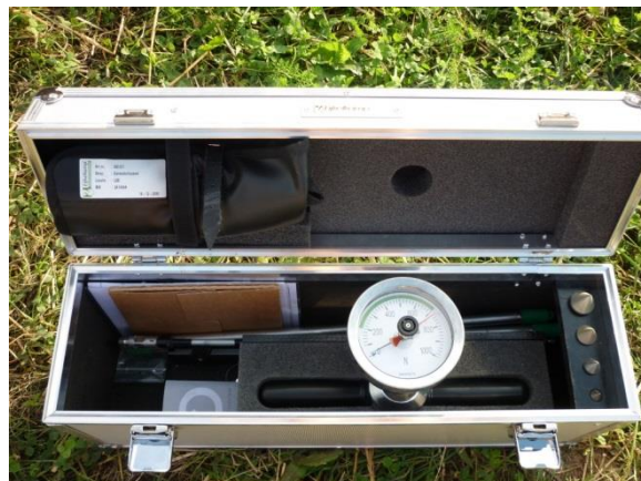
Obr. 93 Penetrometr Eikelkamp použitý k měření slisovanosti balíků, vpravo jsou vidět jednotlivé hroty určené k měření [30]
