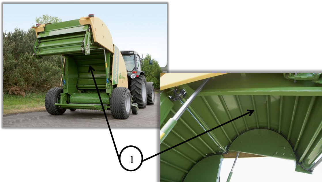
Obr. 13 Lis na válcové balíky firmy Krone s pevnou lisovací komorou a příčkovým dopravníkem [14]
