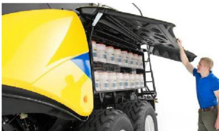
Obr. 86 Umístění klubíček motouzu v lisu NewHolland [21]
