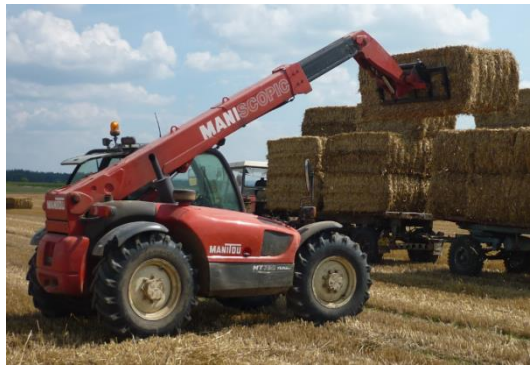
Obr. 91 Manipulátor Manitou nakládající balíky na vleky [30]
