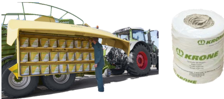
Obr. 85 Umístění klubíček motouzu v lisu Krone [23]
