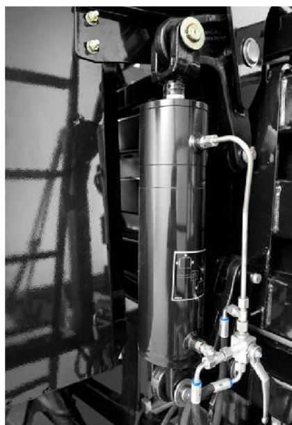
Obr. 66 Hydraulický píst pro nastavení lisovacího tlaku lisu NewHolland [21]
