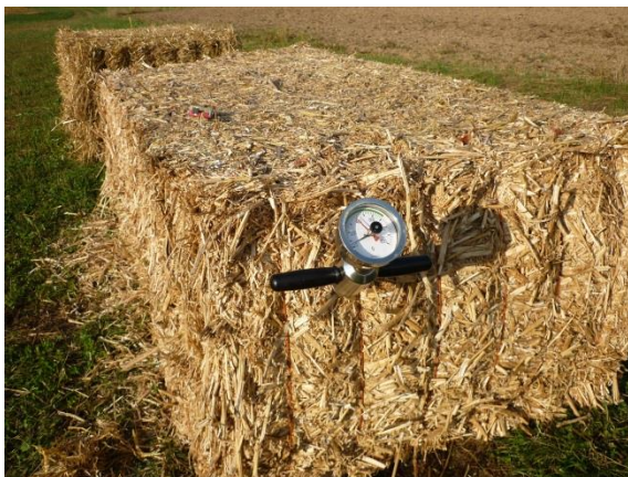
Obr. 89 Postup měření balíku - zde řepková sláma [30]
