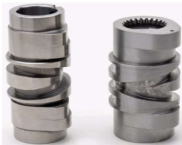
Obr. 16 Příklad vačkových jednotek, jejichž povrch lze povrchově kalit elektronovým paprskem [27]
