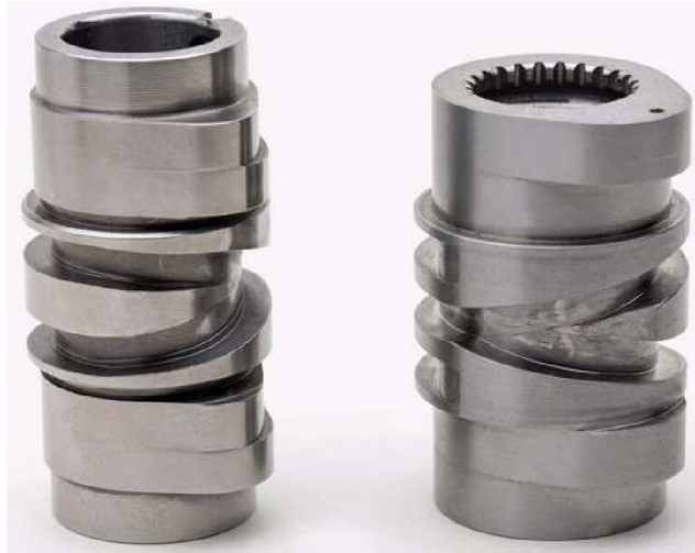
Obr. 16 Příklad vačkových jednotek, jejichž povrch lze povrchově kalit elektronovým paprskem [27]
