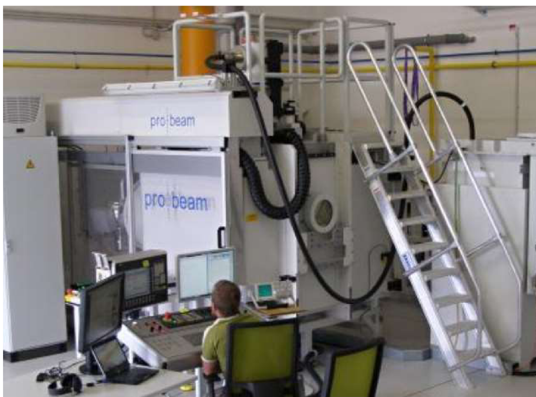
Obr. 22 Zařízení pro přetavení elektronovým paprskem K26 [22]
