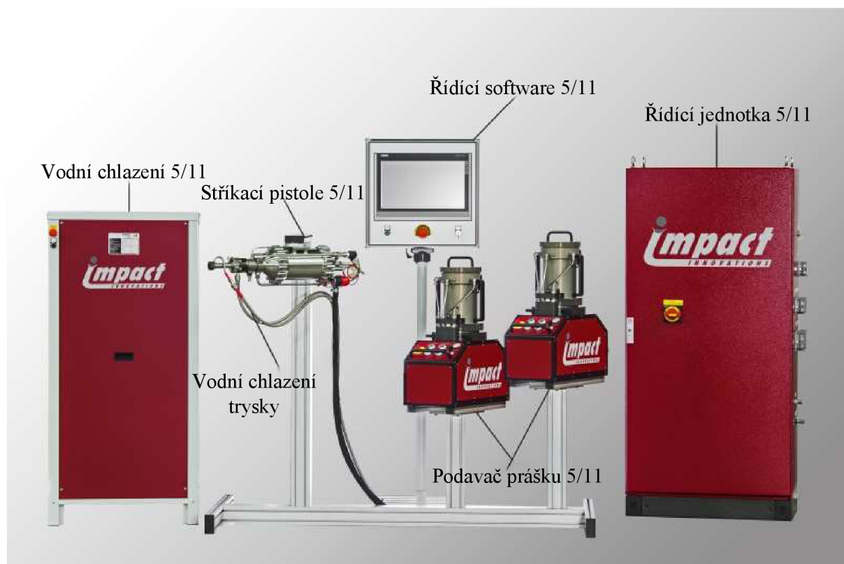
Obr. 21 Zařízení cold spray 5/11 [3]
