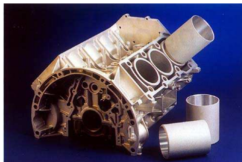
Obr. 14 Blok motoru a vložky válců [26]
