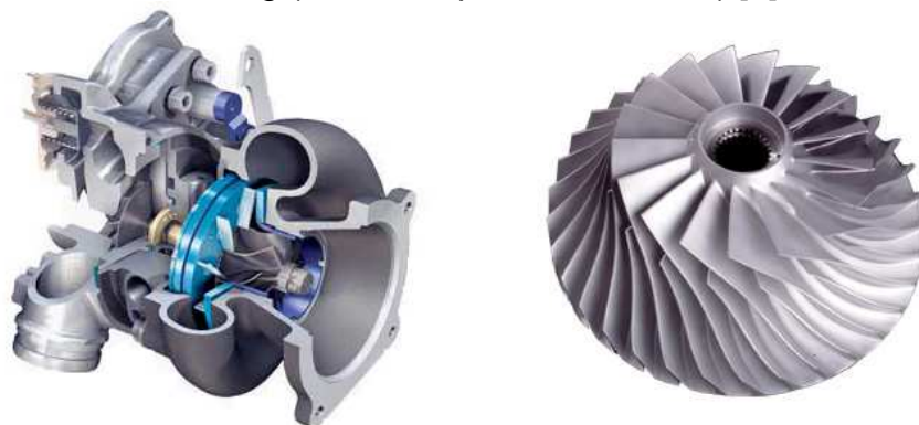
Obr. 18 Turbodmychadlo [29] a rotor turbodmychadla [31]
