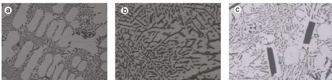
Obr. 9 a) podeutektická, b) eutektická a c) nadeutektická struktura Al – Si [17]
