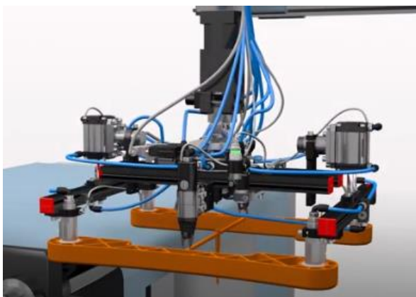
Obr. 16 Odebrání výlisku pomocí měchových chapadel [24]
