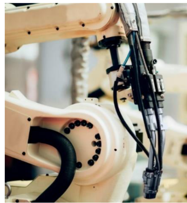
Obr. 3 Technologická hlavice - svařování [4]
