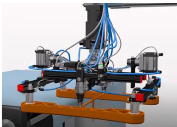
Obr. 16 Odebrání výlisku pomocí měchových chapadel [24]
