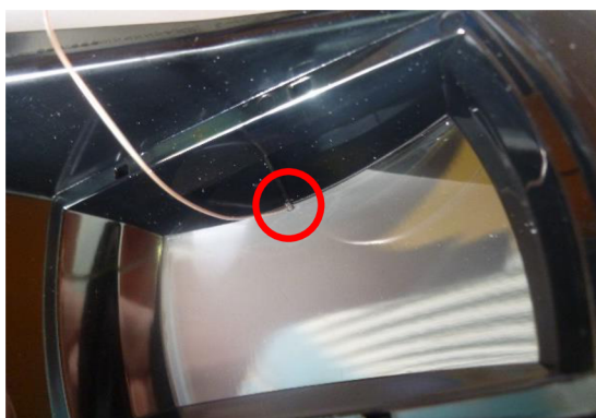
Obr. 39 Umiestnenie termočlánku T2
