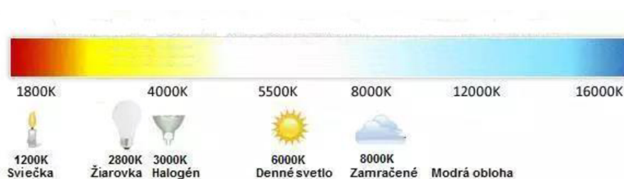
Obr. 6 Spektrum teploty chromatičnosti a porovnanie rôznych svetelných zdrojov [11]
