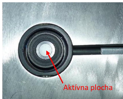
Obr. 45 Aktívna plocha luxmetru Radiolux 111
