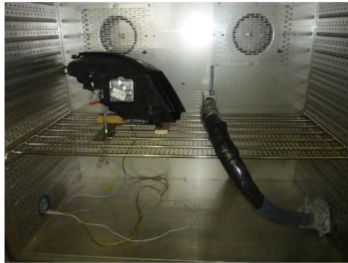
Obr. 30 Umiestnený svetlomet v termostatickej komore aj s nainštalovaným chladením luxmetru
