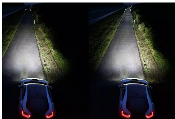
Obr. 24 Porovnanie samostatného diaľkového LED osvetlenia a LED v kombinácii s Laser-om [35]
