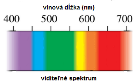
Obr. 5 Viditeľné elektromagnetické spektrum [8]
