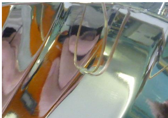
Obr. 38 Umiestnenie termočlánku T7
