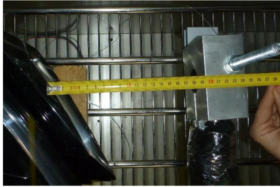
Obr. 44 Umiestnenie luxmetru od svetlometu vo vzdialenosti 0,2 m
