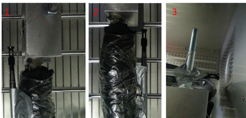
Obr. 54 Polohy anemometru pre meranie rýchlosti prúdenia na troch stenách (zľava 1,2 a 3)
