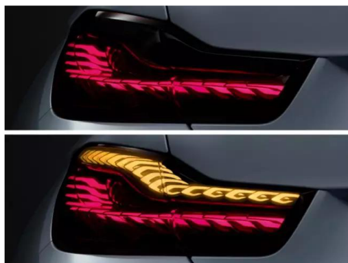
Obr. 26 Ukážka prevedenia OLED pri spätnom osvetlení u BMW [39]
