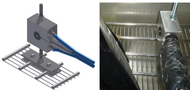
Obr. 52 3D model chladiča (vľavo) a skutočné zariadenie umiestnené v termostatickej komore (vpravo)
