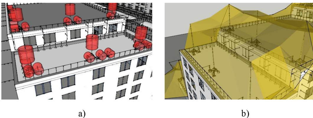
Obrázek 7.21 Jímací soustava na bloku K: a) vyznačení oblasti koncovky (červený válec) a přerušené okružní vedení pro potenciální vstup na střechu, b) ochranný prostor nad blokem K
