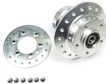
Obr. 42 Náboj kotoučové brzdy značky ZT-Tuning [19]
