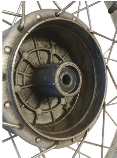
Obr. 5 Třecí plocha bubnové brzdy
