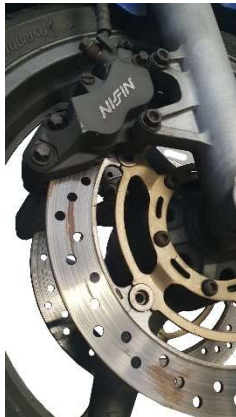
Obr. 8a Plovoucí kotouč v kombinaci s pevným třmenem
