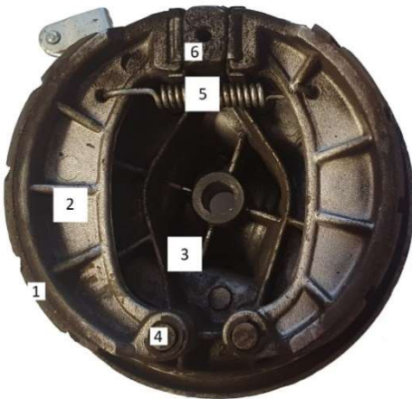
Obr. 4a Bubnová brzda a její části
