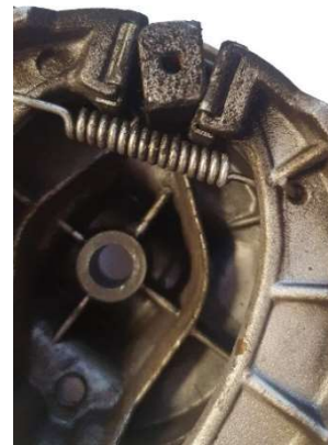
Obr. 4b Otočení brzdového klíče vyvolávající rozevření brzdových čelistí
