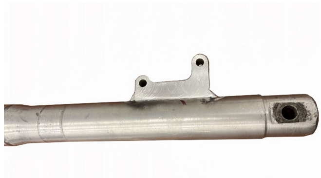
Obr. 32 Upevnění třmene po svaření horních hran a zarovnání čel
