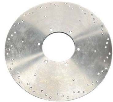
Obr. 35 Polotovar po vrtání děr
