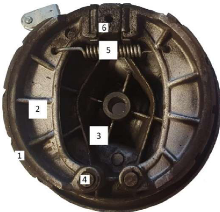
Obr. 4a Bubnová brzda a její části
