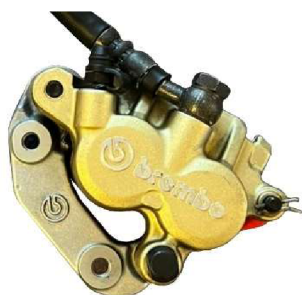
Obr. 20a Třmen BREMBO PF 2x28 mm
