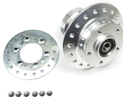
Obr. 42 Náboj kotoučové brzdy značky ZT-Tuning [19]
