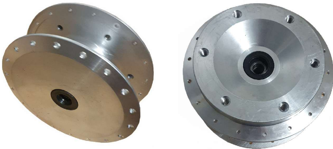
Obr. 28 Náboj kola – již osazený ložisky, pojistnými kroužky, guferý a rozpěrkou
