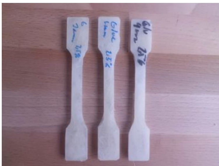
Obr. 22 - Zhotovená víceúčelová zkušební tělesa
