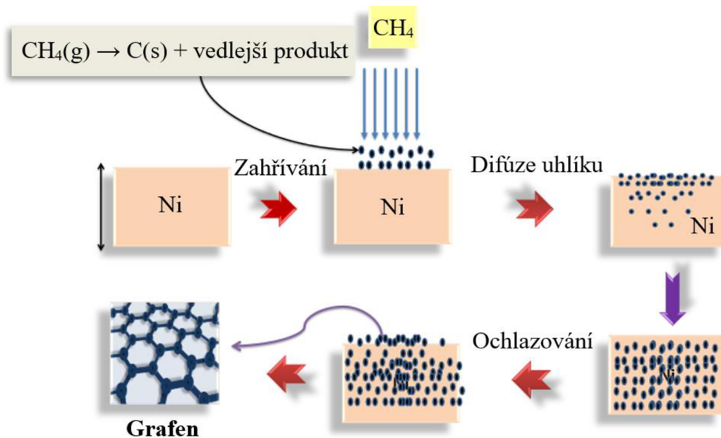
Obrázek 2.2 Mechanismus růstu grafenu na niklovém substrátu metodou CVD [40]
