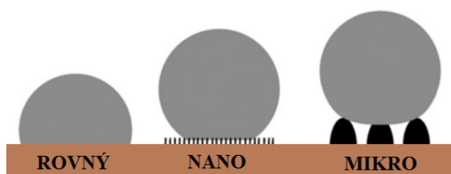
Obr. 2.12: Rozdíl ve smáčivosti odlišných povrchů - pokud je kontaktní úhel na hladkém povrchu větší než 90^\circ , kontaktní úhel na nanostrukturovaném povrchu vzroste
