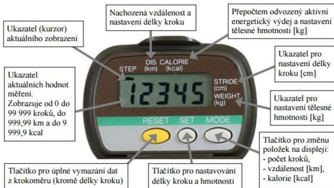
Obrázek 7. Displej krokoměru Yamax Digiwalker SW-700 s popisem ovládacích prvků (převzato od Sigmunda, 2012, 13)
