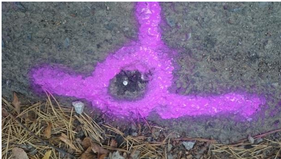
Obrázek 4.2: Ukázka dočasné stabilizace nastřelovacím hřebem.
