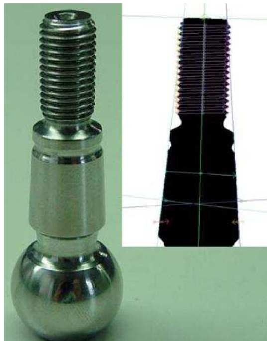
Obr. 2–2 Aplikace inteligentní kamery při kontrole kulového čepu. Zdroj: (Havle, 2009)
