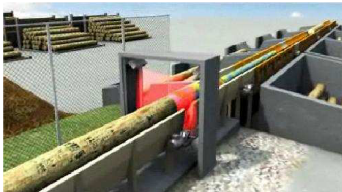
Obr. 2–6 3D kamera SICK Ruler (vlevo) a její aplikace při 3D měření (vpravo). Zdroj: (SICK AG, c2010)
