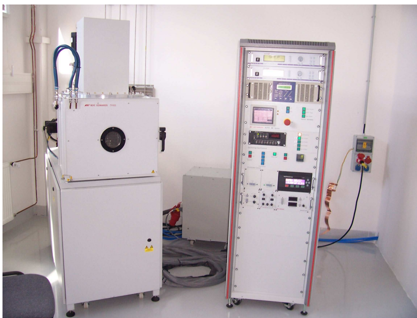
Obr.6.1: Fotografie celé depoziční aparatury
