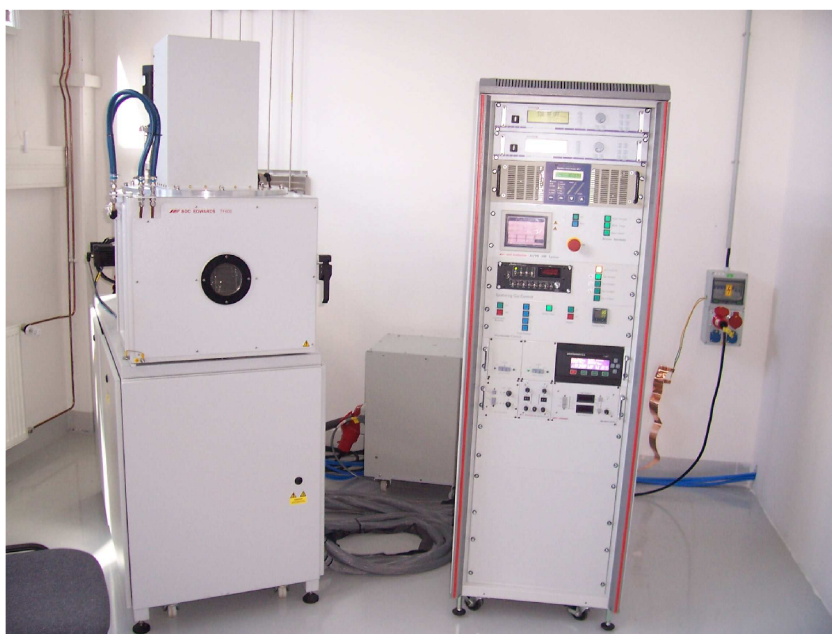
Obr.6.1: Fotografie celé depoziční aparatury
