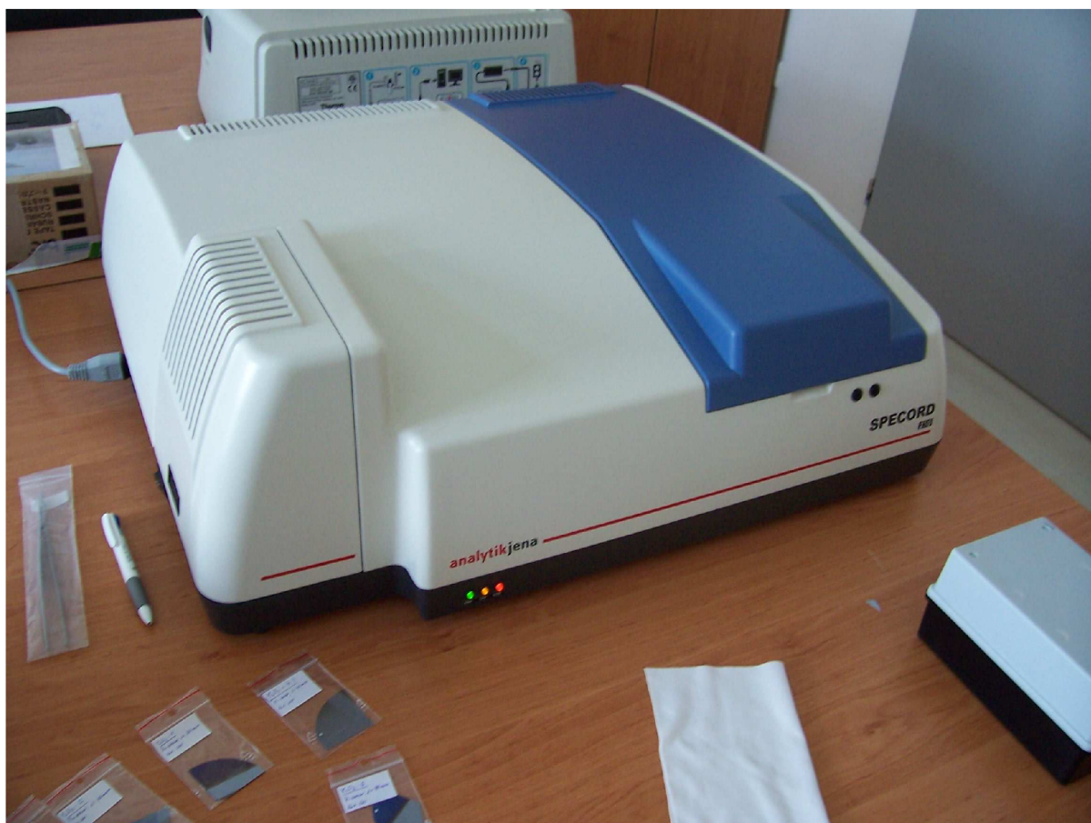
Obr.5.2: Fotografie spektrofotometru SPECORD 210
