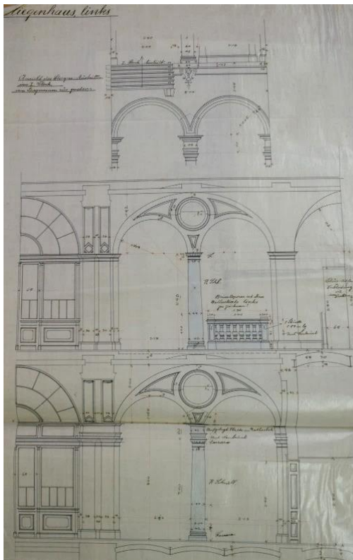
Obr. 36 Nákres schodišťového prostoru nalevo od dvorany.
