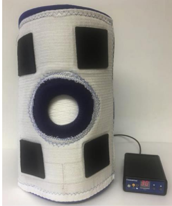
Obrázok 11. E-sleeve (prevrátený naopak, aby boli viditeľné elektródy) a pripojená elektronická riadiaca jednotka (Liu et al., 2020, str. 2)
