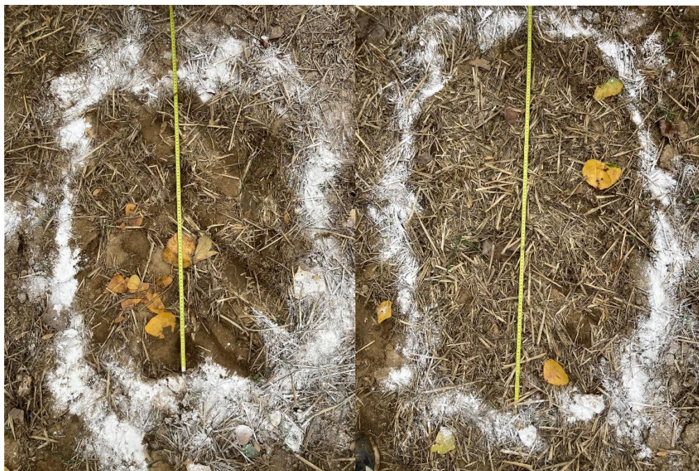
Obrázek 4.10: Porovnání styčné plochy zadní pneumatiky traktoru
