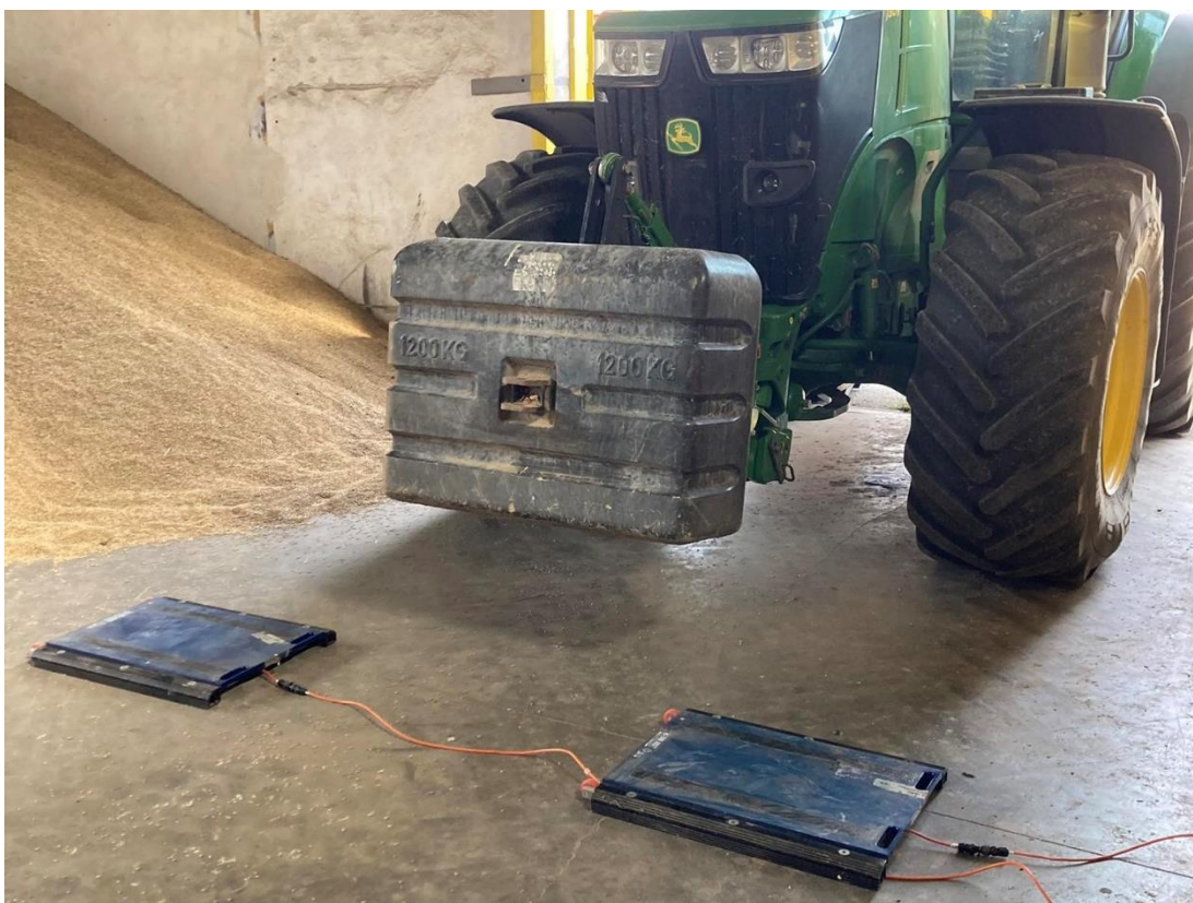
Obrázek 3.2: Přenosné nájezdové váhy před měřením zatížení náprav
