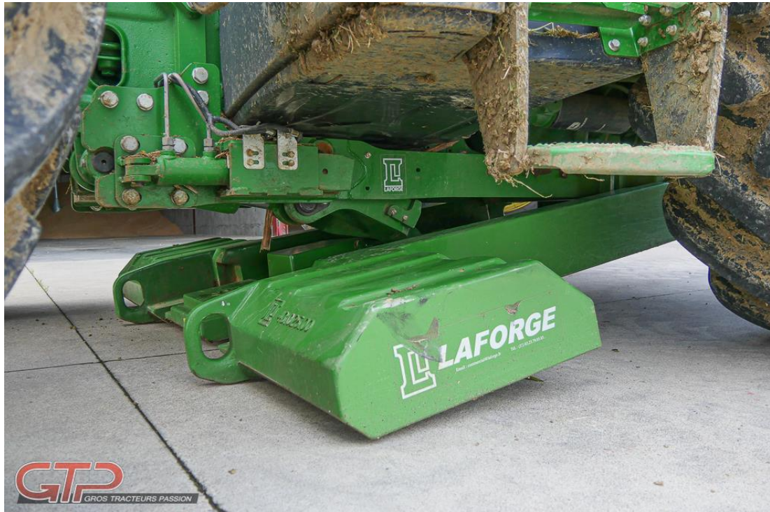
Obrázek 1.6: Připojování závaží EZ Ballast k traktoru (Deschamps, 2022)
