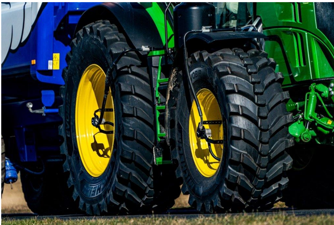
Obrázek 1.4: Dezén hybridních traktorových pneumatik Michelin EvoBib (Jedlička, 2023)
