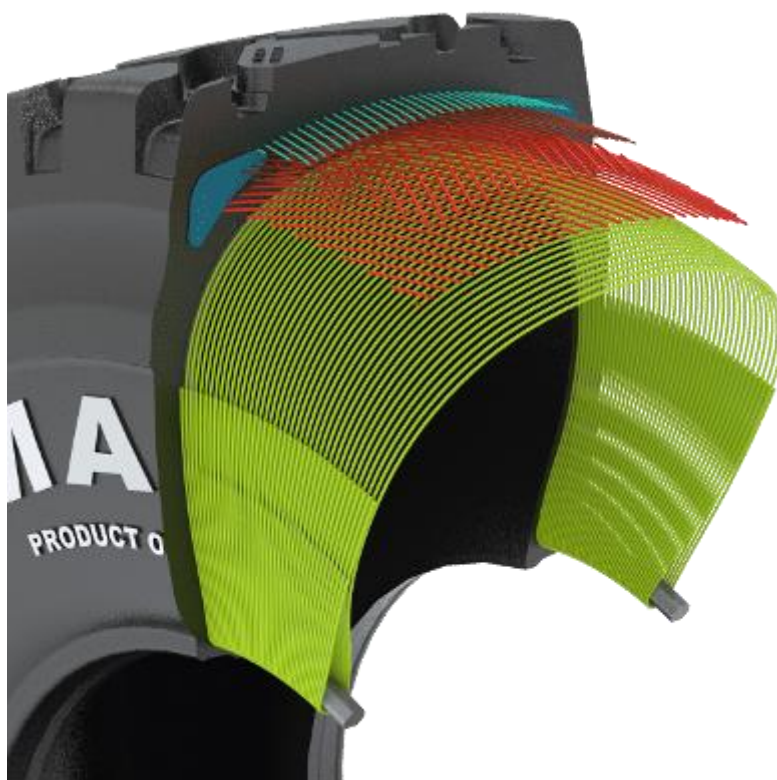
Obrázek 1.3: Průřez radiální pneumatikou (MagnaTyres.com, 2023)
