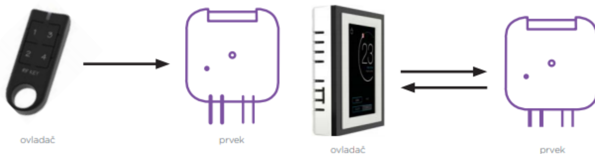
Obr. 6 Jednosměrná a obousměrná komunikace [23]
