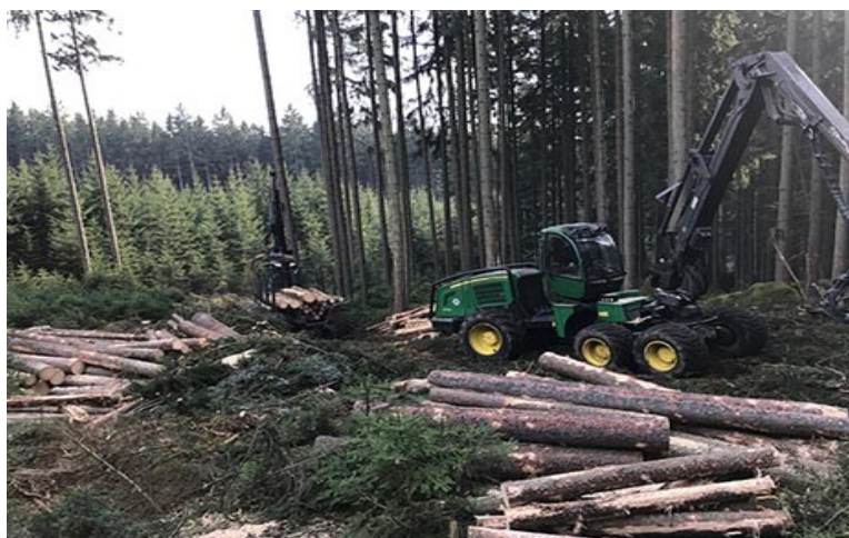
Obr. 4: Těžební metoda sortimentní
