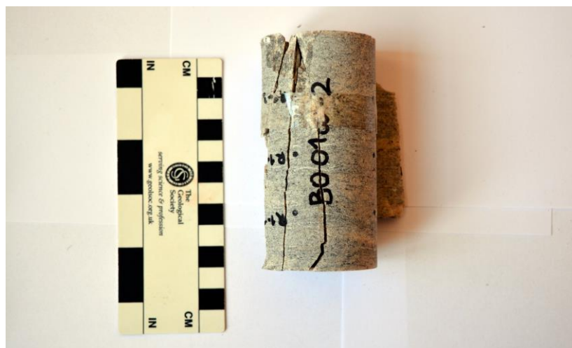
Obr. 32: Ukázka křehkého porušení vzorků granulitu z Horních Borů po jednoosé zkoušce.
