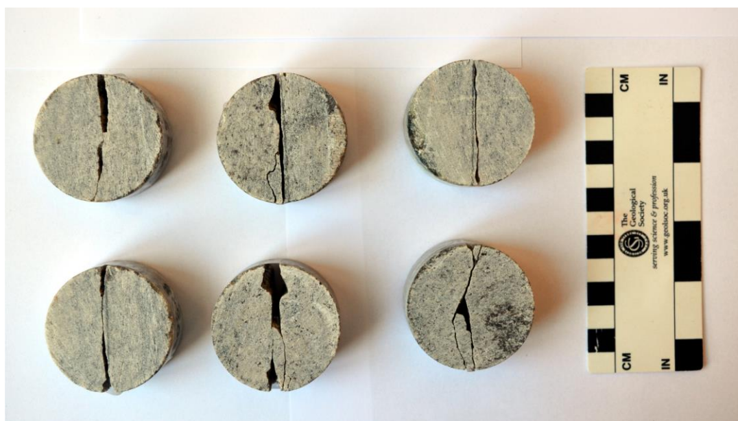
Obr. 31: Ukázka tahového porušení vzorků granulitu z Horních Borů.
