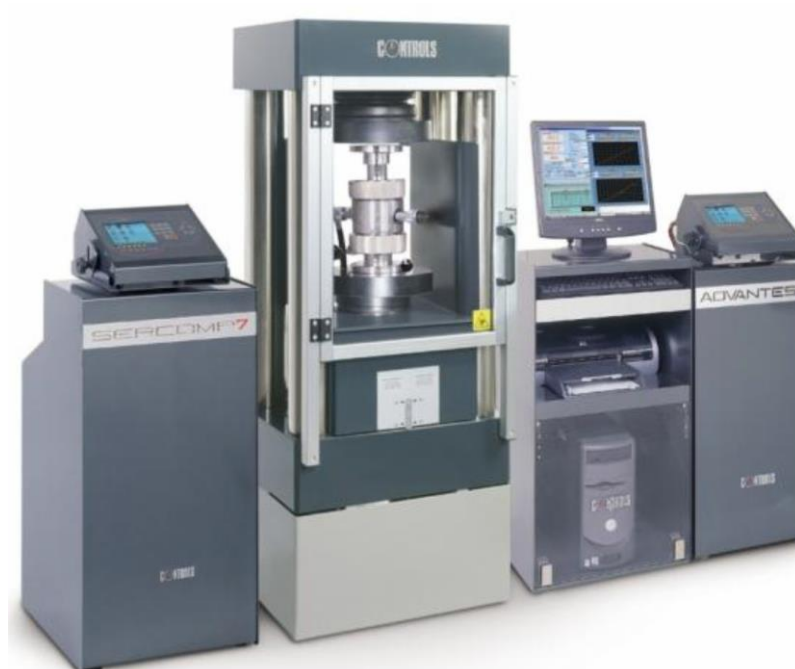
Obr. 17: Měřicí přístroj ADVANTEST 9 ROCK od italského výrobce Controls Group využívaný v laboratoři vědecko-výzkumného centra AdMaS. Foto: www.controls-group.com .
