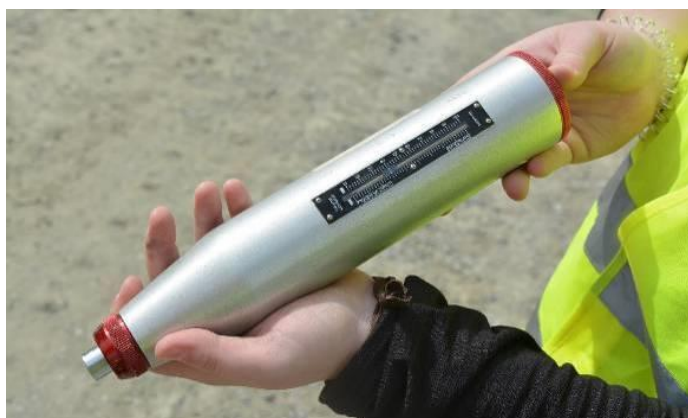
Obr. 2: Terénní studium skleroskopické tvrdosti pomocí Schmidtova kladívka typu L.
