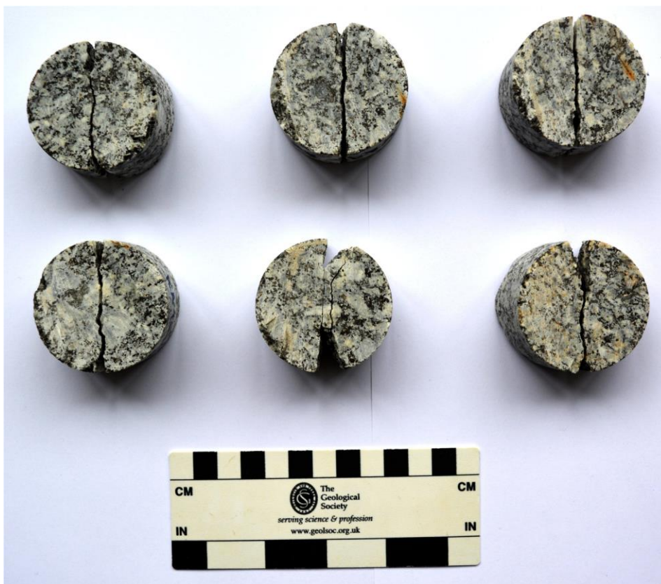
Obr. 26: Ukázka tahového porušení vzorků durbachitu z Kamenné.
