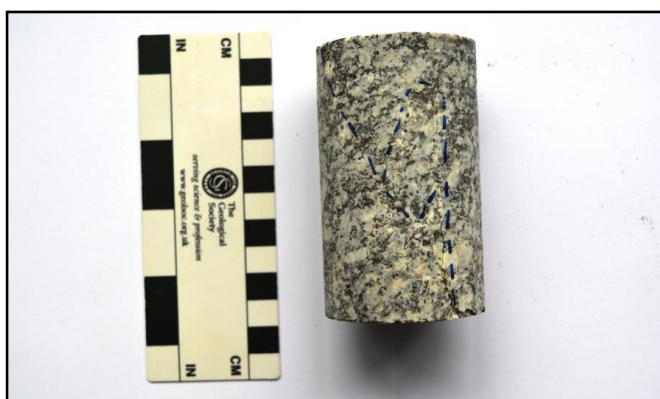
Obr. 16: Ukázka testovaného tělesa durbachitu z lokality Kamenná (třebíčský masiv).
