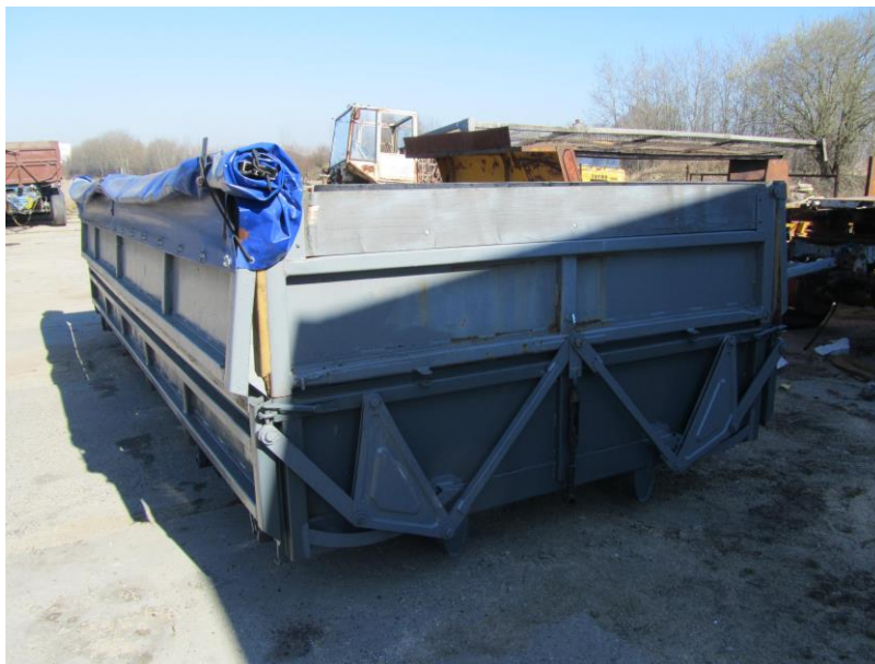
Obrázek 16: Dvoudílná korba pro sypké materiály - mechanismus otevírání bočnic
