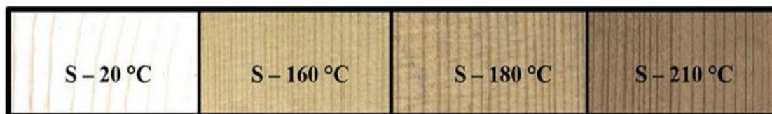
Obrázek 6: Barva smrkového dřeva při jednotlivých teplotách modifikace
