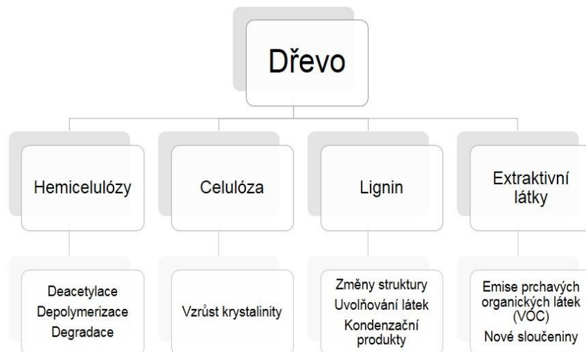
Obrázek 7: Termická degradace hlavních složek dřeva
