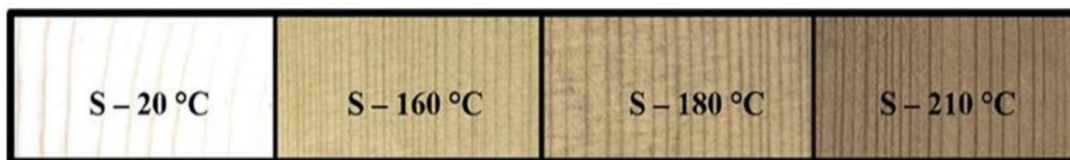
Obrázek 6: Barva smrkového dřeva při jednotlivých teplotách modifikace
