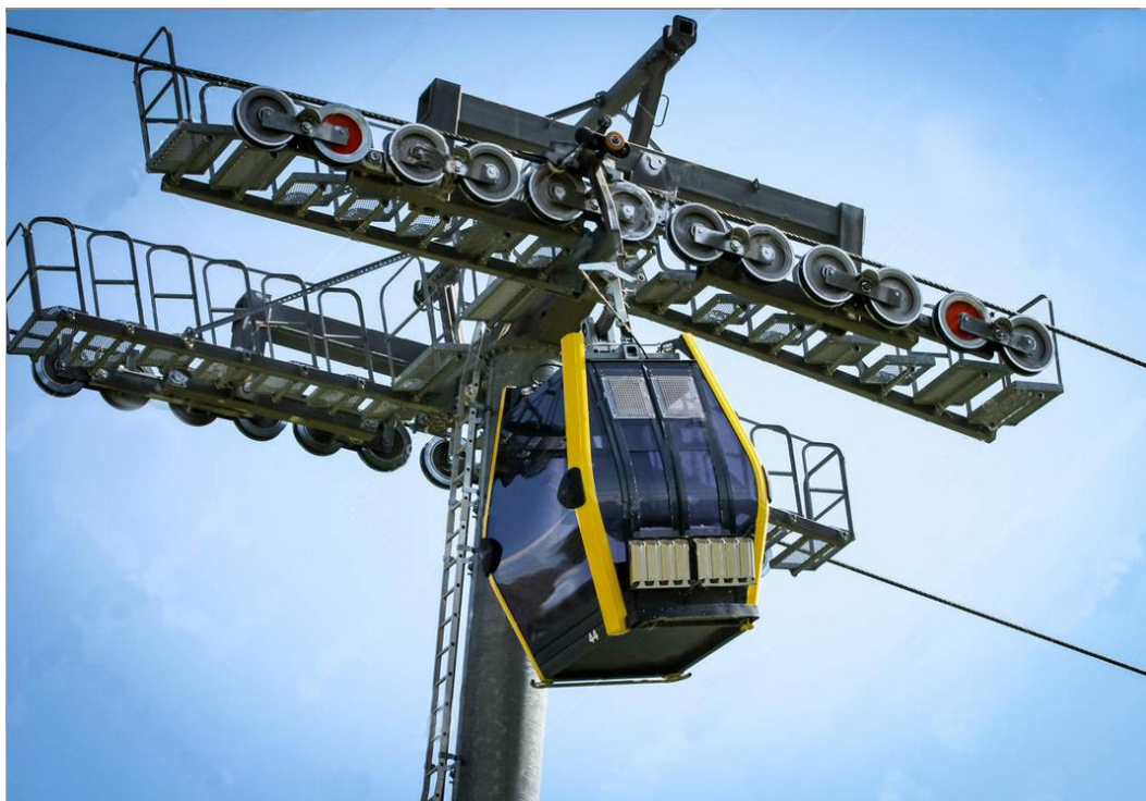
Obr. 5 Využití kldky na lanových drahách [5]
