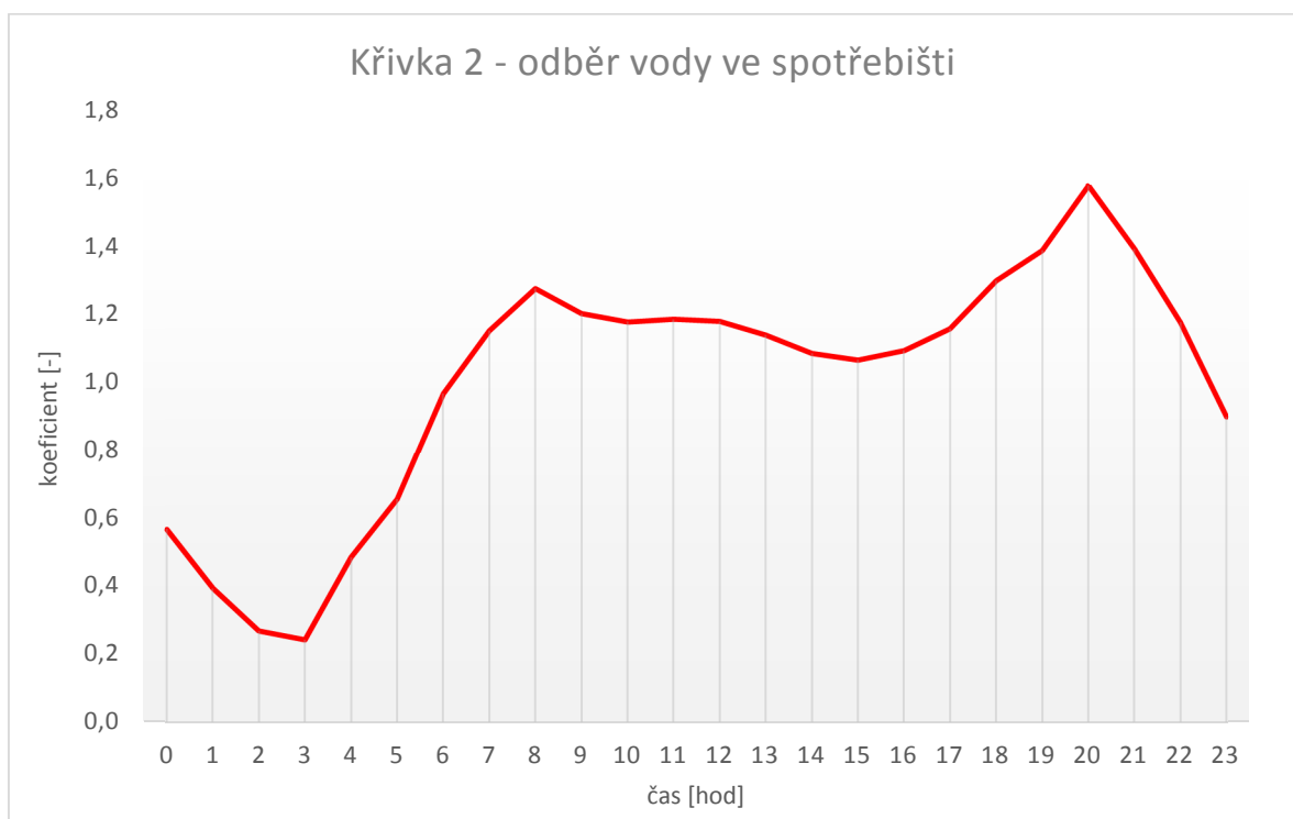
Obr. 38 Křivka 2 - vyjadřující odběr vody ve spotřebišti.
